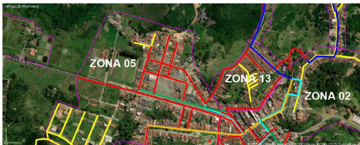
Figura 25 – Zoneamento e traçado das tubulações de Bananeiras.
