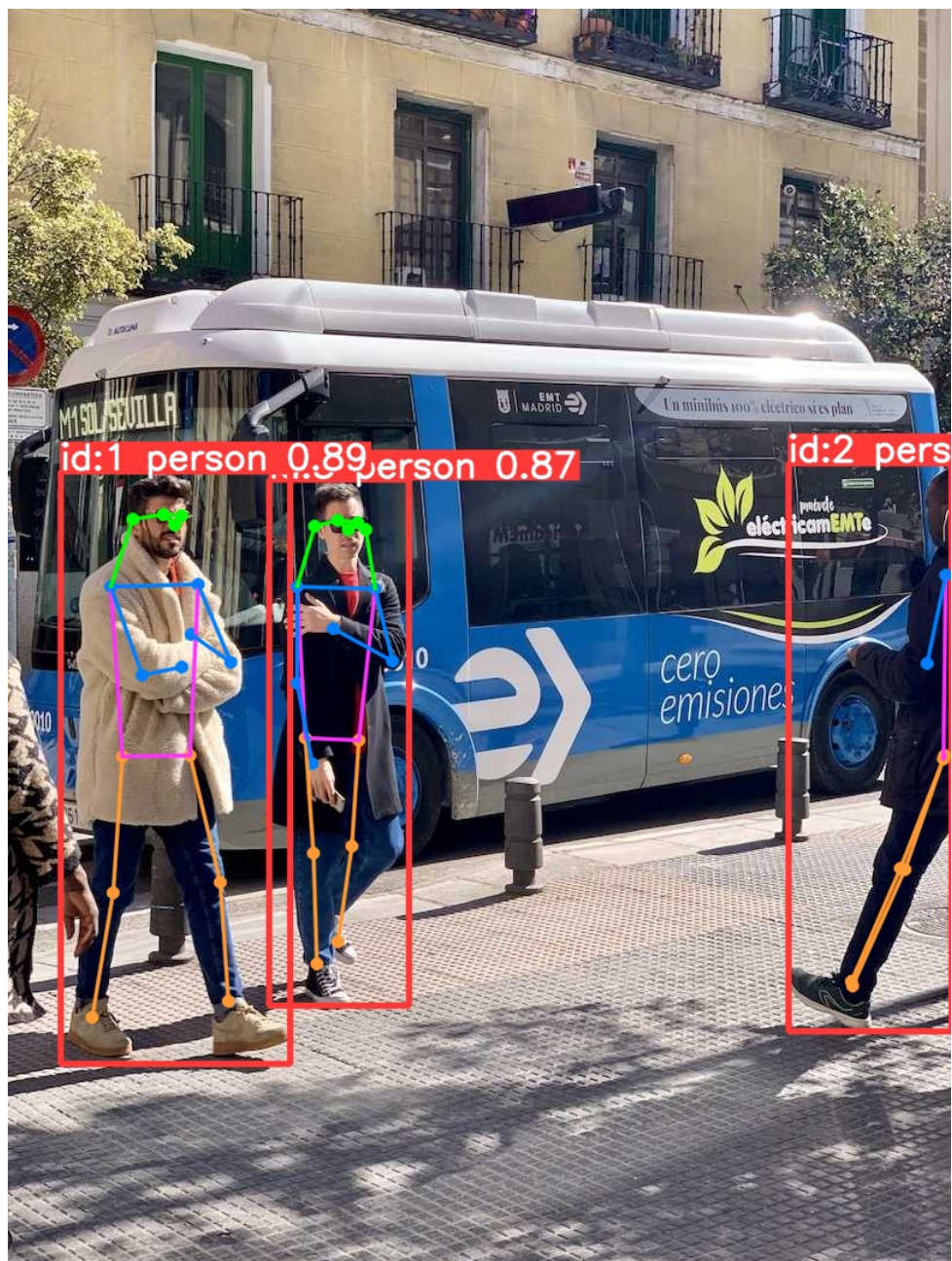
Figura 8: Imagem mostrando objetos da classe 'person' com a estimativa de pose de cada indivíduo detectado. Fonte: Imagem adaptada de [36].
