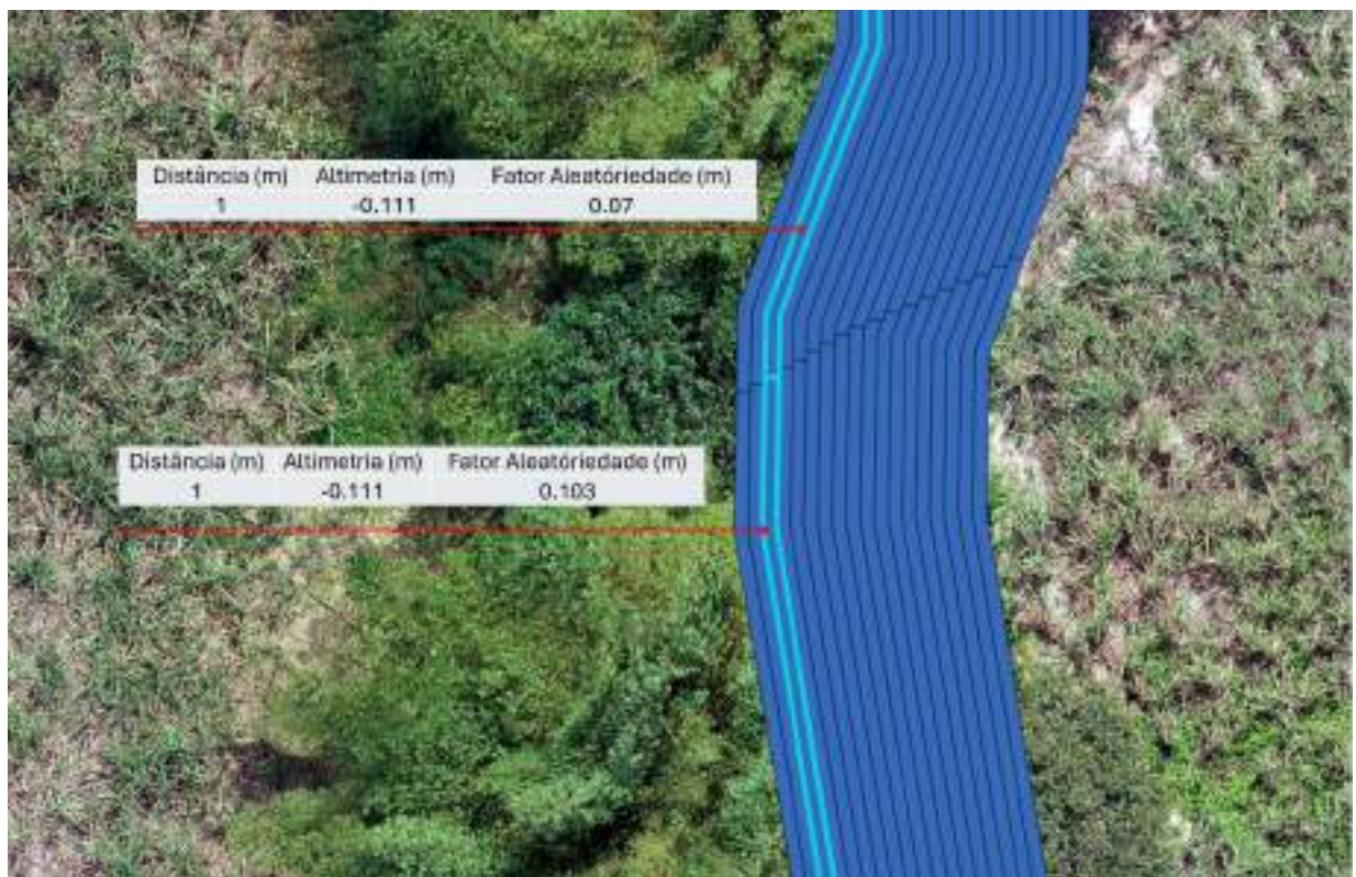
Figura 17 – Ilustração em esquema de uma seção dos blocos, com seus respectivos valores de batimetria e fator aleatório.
