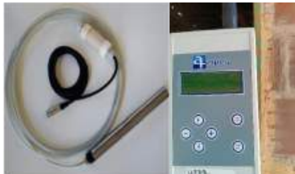
Figura 9 – Sensor de nível e Datalogger da Ampeq.
