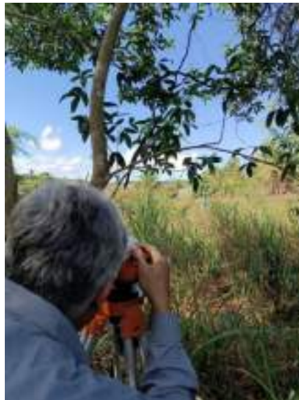
Figura 14 – Realização da Topo-batimetria com nível e mira de alumínio.
