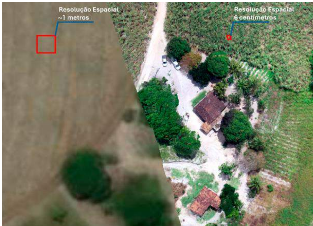
Figura 21 – Comparação da Resolução Espacial entre a imagem do Google e o Ortomosaico.
