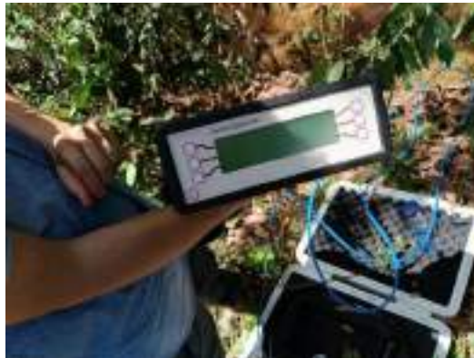
Figura 8 – Micromolinete utilizado para as medições de velocidade
