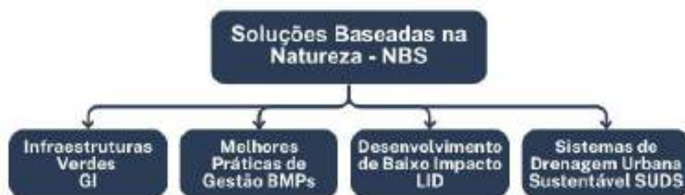
Figura 03: Fluxograma: Esquema de distinções dos sistemas de soluções baseadas na natureza.
