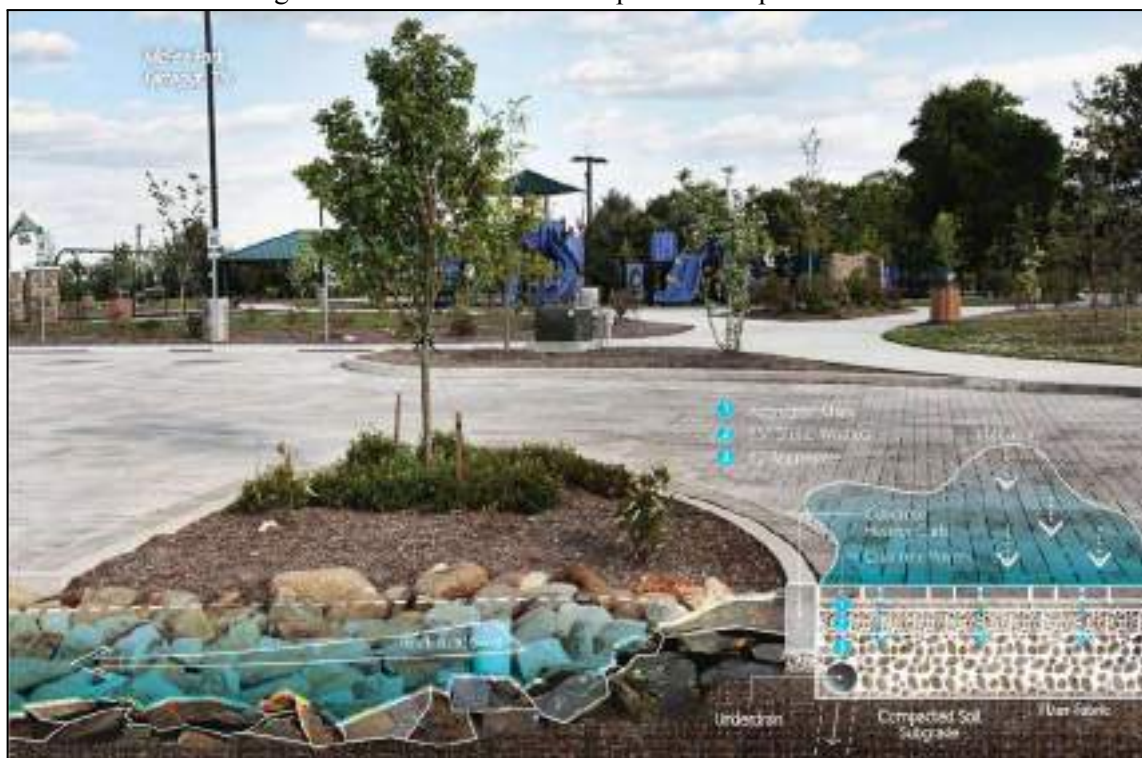
Figura 15: Funcionamento dos pavimentos permeáveis.
