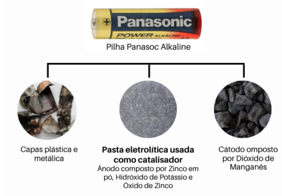
Figura 3 - Representação esquemática dos constituintes da pilha Panasonic Alkaline.
