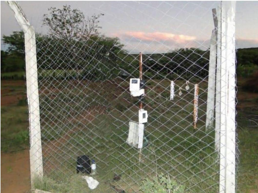
*Figura 2: Estação meteorológica de Caraúbas*
