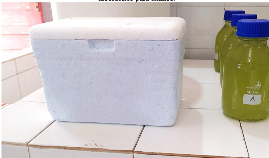
Figura 3 - Amostras de água da Lagoa do Paó acondicionadas em frascos de polietileno de 500 mL, identificadas e armazenadas em caixa térmica de isopor, garantindo conservação adequada até a chegada ao laboratório para análise.
