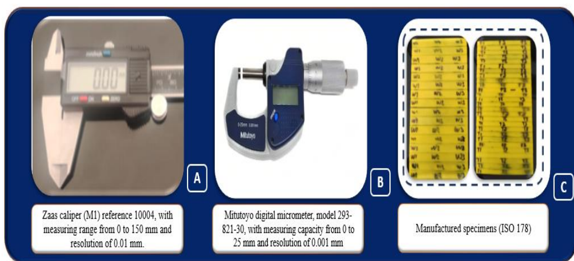
Figura. 4: Paquímetro digital utilizado para as medições e micrometro utilizado para determinar Y_{ref} e espécimes fabricadas e utilizadas no experimento
