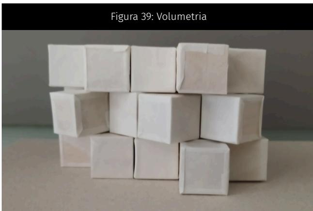
O segundo experimento foi baseado no Castelo de Kafka de Ricardo Bofill, a volumetria (fig. 39) é composta por um módulo base em cruz (fig. 35), o qual gira em torno do bloco de circulação em cada nível (fig. 36, 37 e 38), gerando balanços que dão uma certa complexidade ao todo.
