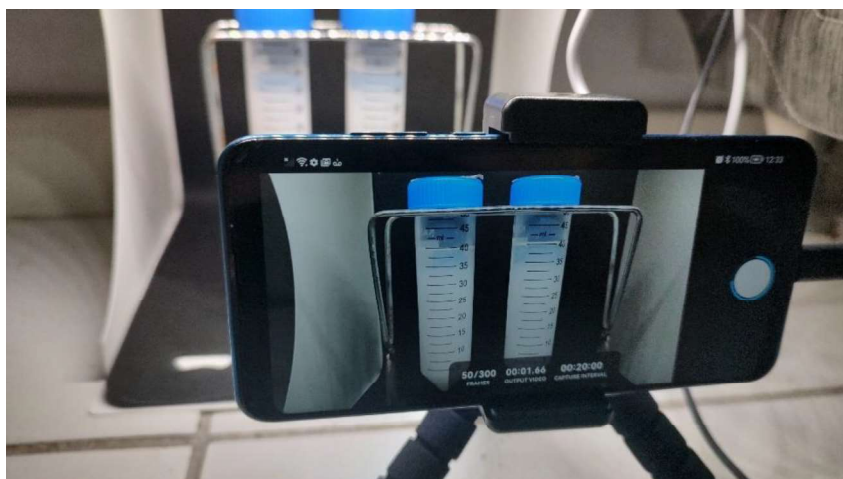
Figura 30. Mini estúdio para monitoramento da decantação e estabilidade das dispersões
