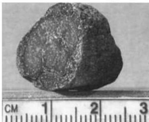
Figura 6. Grão de um clínquer de cimento Portland com uma face cortada e polida.
