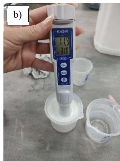
Figura 31. a) Amostras preparadas para o monitoramento do pH e b) pHmetro utilizado nas medições.
