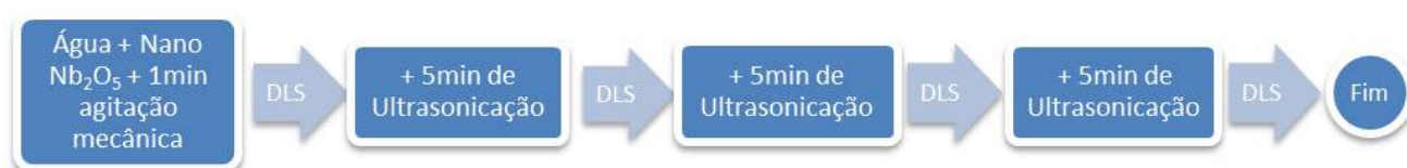
Figura 28. Fluxograma de ensaio DLS potencial com utilização de ultrasonicação
