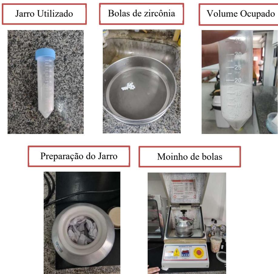
Figura 24. Equipamentos e materiais utilizados na moagem do Nb 2 O 5
