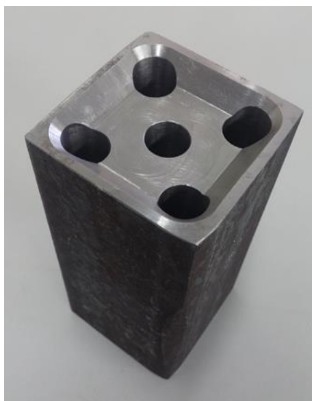
Figura 10 - Molde para obtenção dos lingotes.
