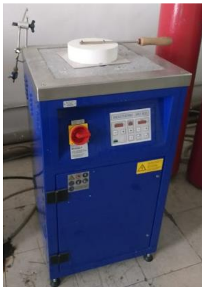
Figura 9 – Forno de indução sem atmosfera controlada.
