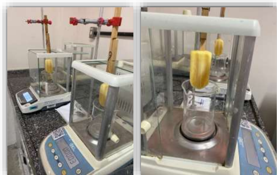
Figura 7 – Sistema montado para a análise de derretimento.
