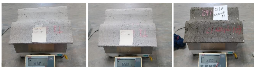
Figura 21. Telhas de concreto (TC) durante o ensaio de permeabilidade
