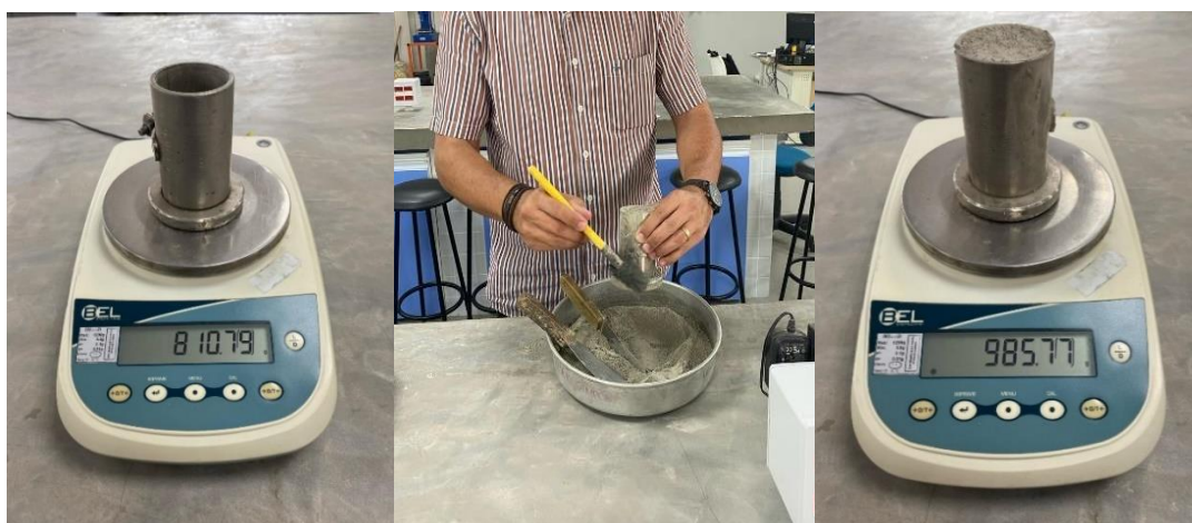
Figura 8. Etapas da realização do ensaio de massa unitária
