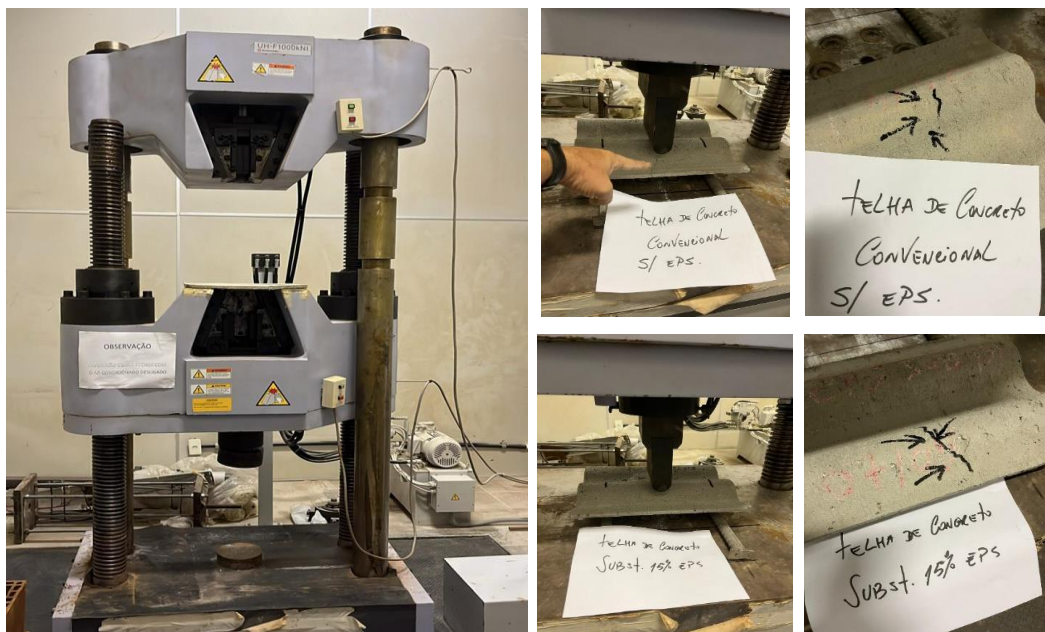
Figura 16. Ensaio mecânico de resistência à flexão
