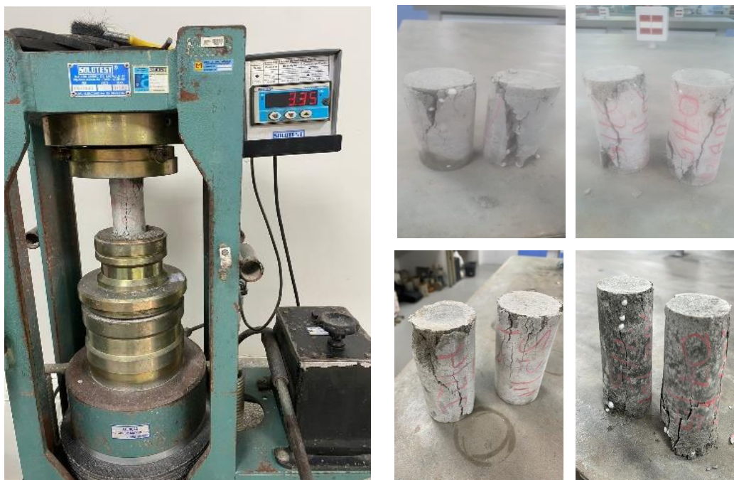
Figura 17. Ensaio mecânico de resistência à compressão
