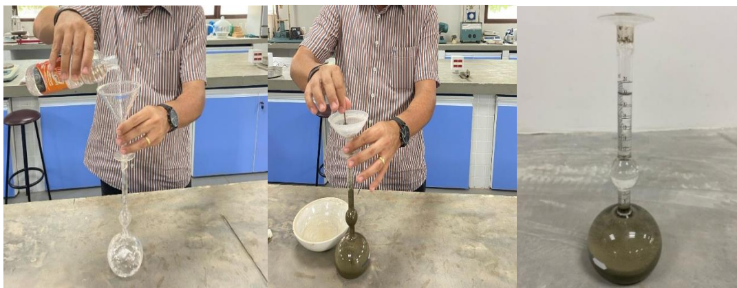
Figura 7. Etapas da realização do ensaio de massa específica do cimento
