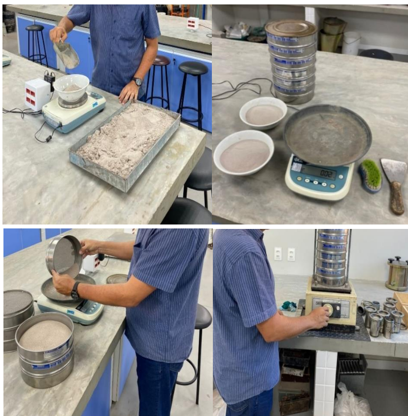
Figura 6. Preparação para realização da curva granulométrica do agregado
