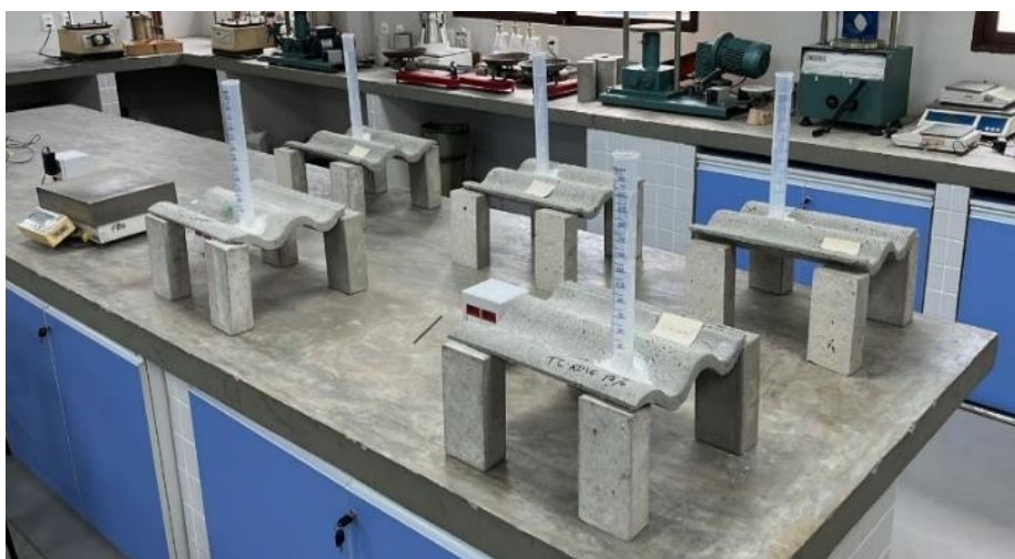
Figura 15. Ensaio de permeabilidade das telhas de concreto
