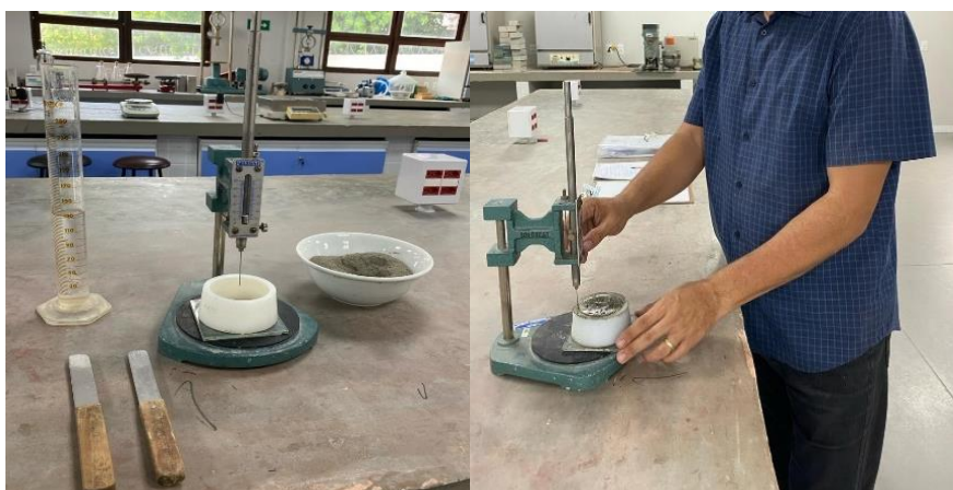
Figura 9. Procedimento para o ensaio de determinação da consistência e tempo de início e fim de pega da pasta do cimento
