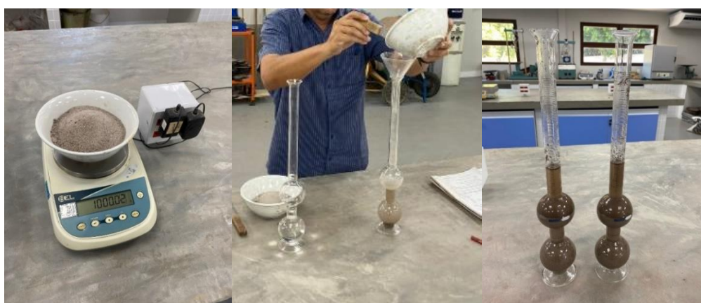
Figura 4. Ensaio de massa específica do agregado miúdo
