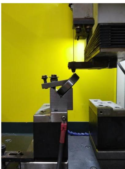
**Figura 4.18**- Processo de fabricação de uma falha simulada usando eletroerosão.
