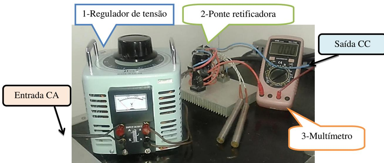
**Figura 4.7-**Sistema de acionamento do motor CC: [1] regulador de tensão; [2] ponte retificadora; [3] multímetro.
