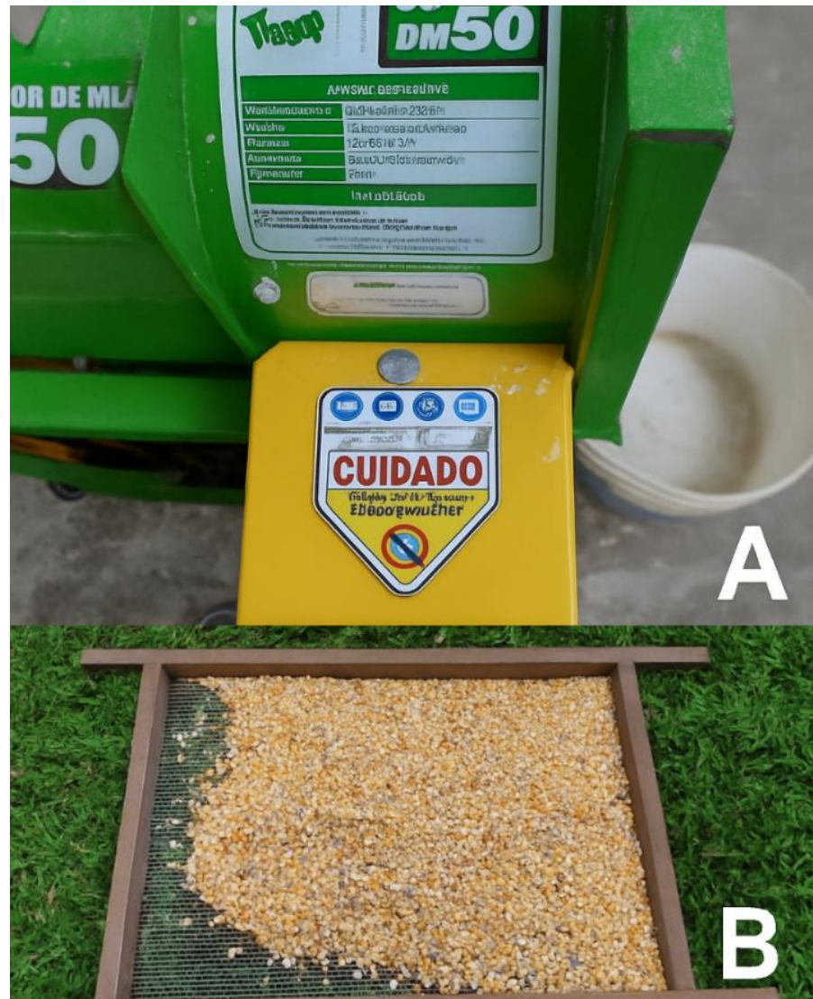
Figura 7. A - Debulhadora mecânica modelo DM50 Trapp, utilizada na debulha das espigas de milho; B - Peneira de construção utilizada no processo de peneiramento dos grãos recém debulhados.
