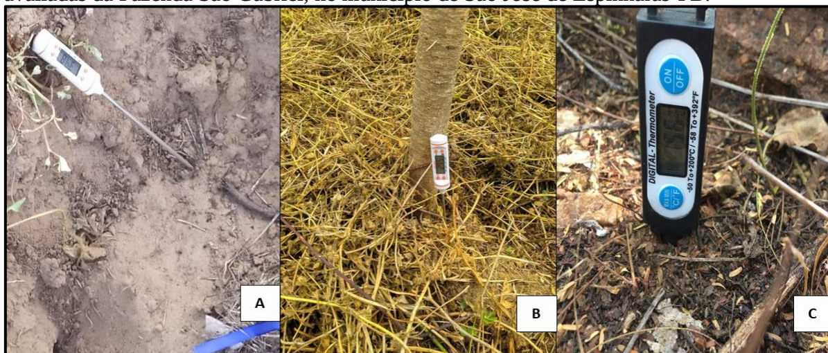
Figura 8 – Medição da temperatura (°C) do solo utilizando o termômetro digital tipo espeto na superfície (A); na profundidade de 7,5 cm (B) e na profundidade de 15 cm (C) nas três áreas avaliadas da Fazenda São Gabriel, no município de São José de Espinharas-PB.
