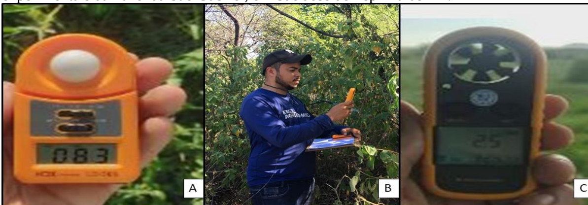
Figura 6 – Instrumentos utilizados para aferir a luminosidade (A): luxímetro; a velocidade do vento, anemômetro (B) e o termômetro digital (C) para temperatura ambiente nas áreas experimentais da Fazenda São Gabriel, em São José de Espinharas-PB.
