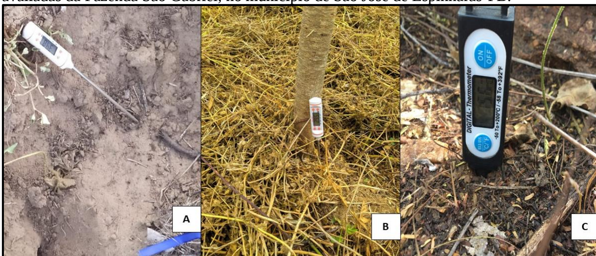
Figura 5 – Medição da temperatura (°C) do solo utilizando o termômetro digital tipo espeto na superfície (A); na profundidade de 7,5 cm (B) e na profundidade de 15 cm (C) nas três áreas avaliadas da Fazenda São Gabriel, no município de São José de Espinharas-PB.
