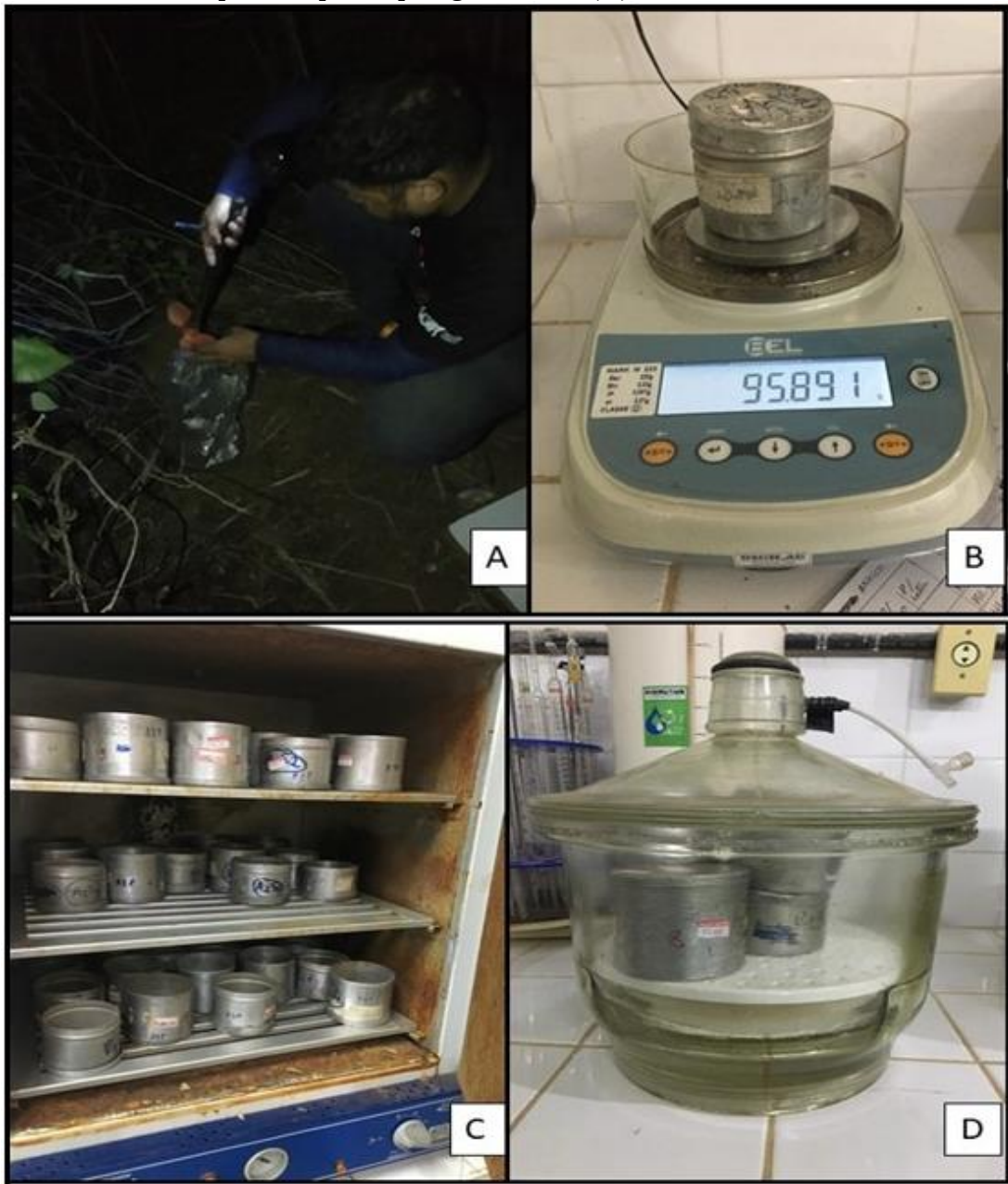
Figura 4 – Coletas de solo para análise de conteúdo de água (A); Pesagem das cápsulas de alumínio para obter a Mu (B); Cápsulas de alumínio na estufa a 105° C (C) e retirada das cápsulas de alumínio após 24h para a pesagem da Ms (D).
