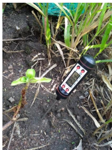
Figura. 5 - Termômetro posicionado no solo para aferição da temperatura.
