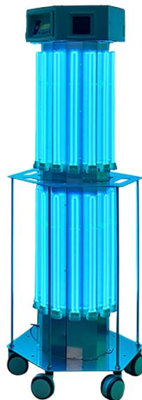
Figura 15: Dispositivo Robô Biolux 360 Plus - Tecnologia UVGI.
