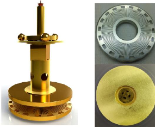
Figura 3.2: Último setup experimental do grupo Eot-Wash realizado em 2020. As massas faltantes nele são muito maiores em número, quando comparada com seus antecessores. Figura retirada de [9].
