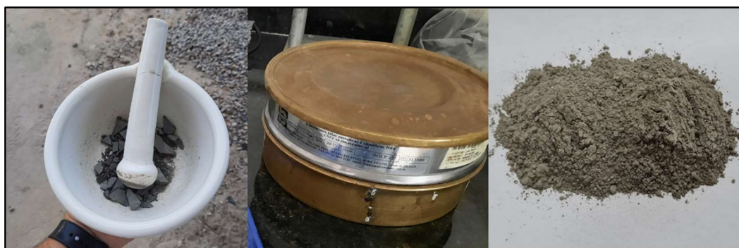
Figura 20 – Preparação das amostras para DRX – Desagregação, peneiramento e material para ensaio. (Fonte: AUTORIA PRÓPRIA, 2024).
