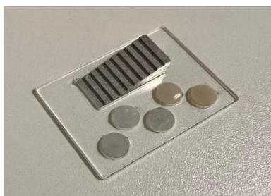
**Figura 8** – Matriz de alumínio utilizada como padrão referência para medir a radiopacidade de materiais dentários. (Fonte: autoria própria).
