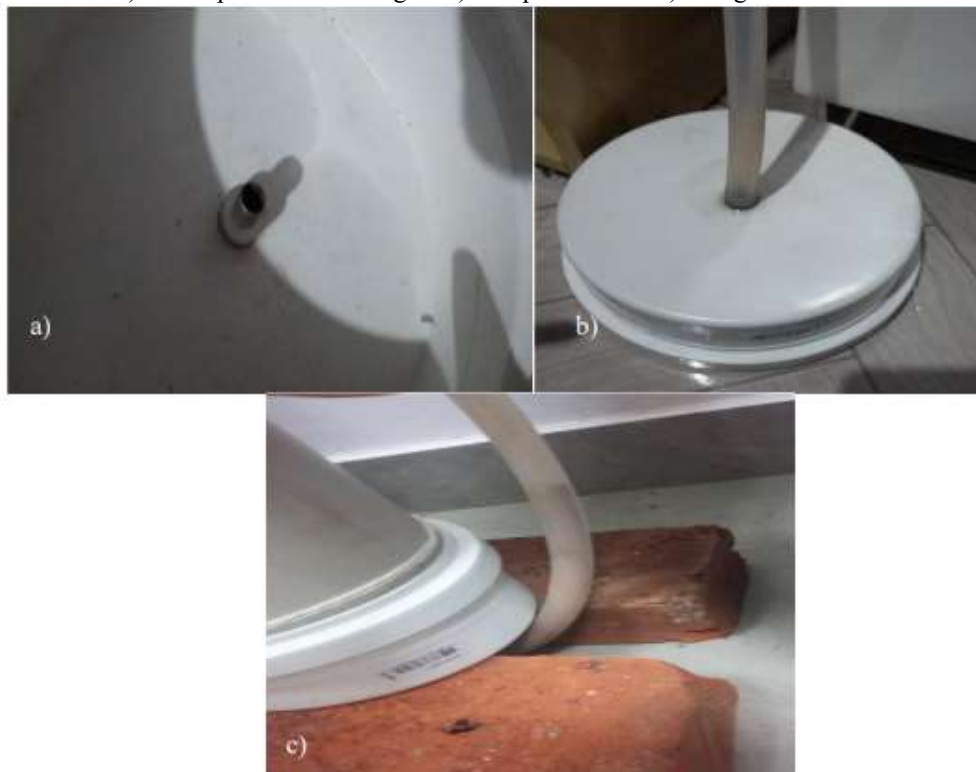
Figura 37: Estrutura suporte do filtro montado por Oliveira (2021). a) Dreno para a saída de água. b) Tampa de PVC. c) Mangueira de Silicone.
