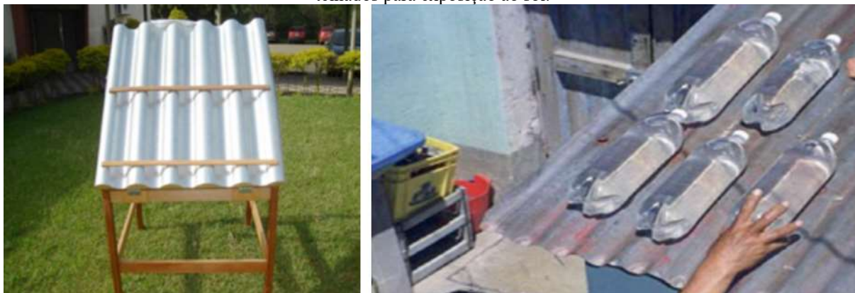
Figura 84: À esquerda: Estrutura suporte para os ensaios SODIS. À direita: Disposição de garrafas PET em telhados para exposição ao sol.
