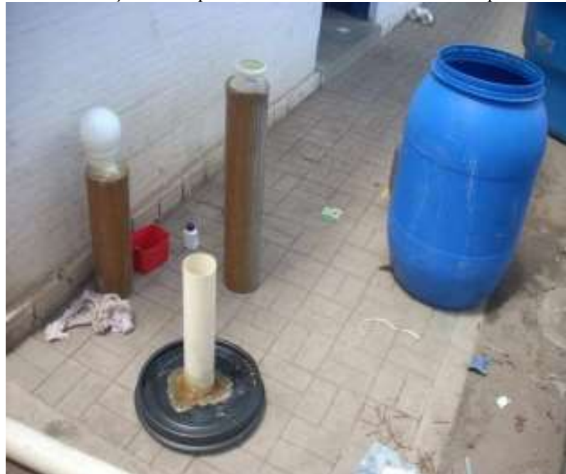
Figura 18: Construção dos dispositivos automáticos de descarte das primeiras águas
