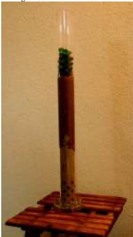
Figura 55: Filtro 1 - filtro de areia
