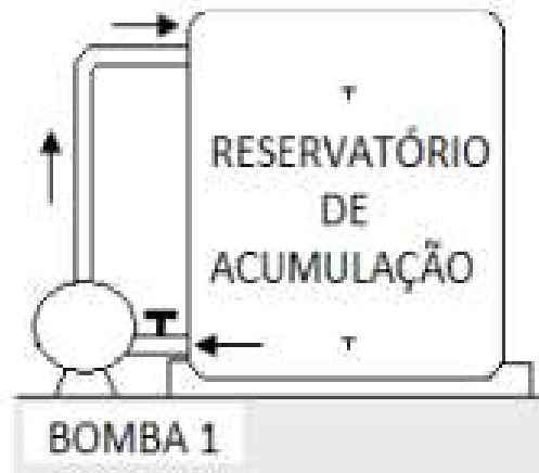
Figura 50: Processo de homogeneização da água do reservatório de acumulação
