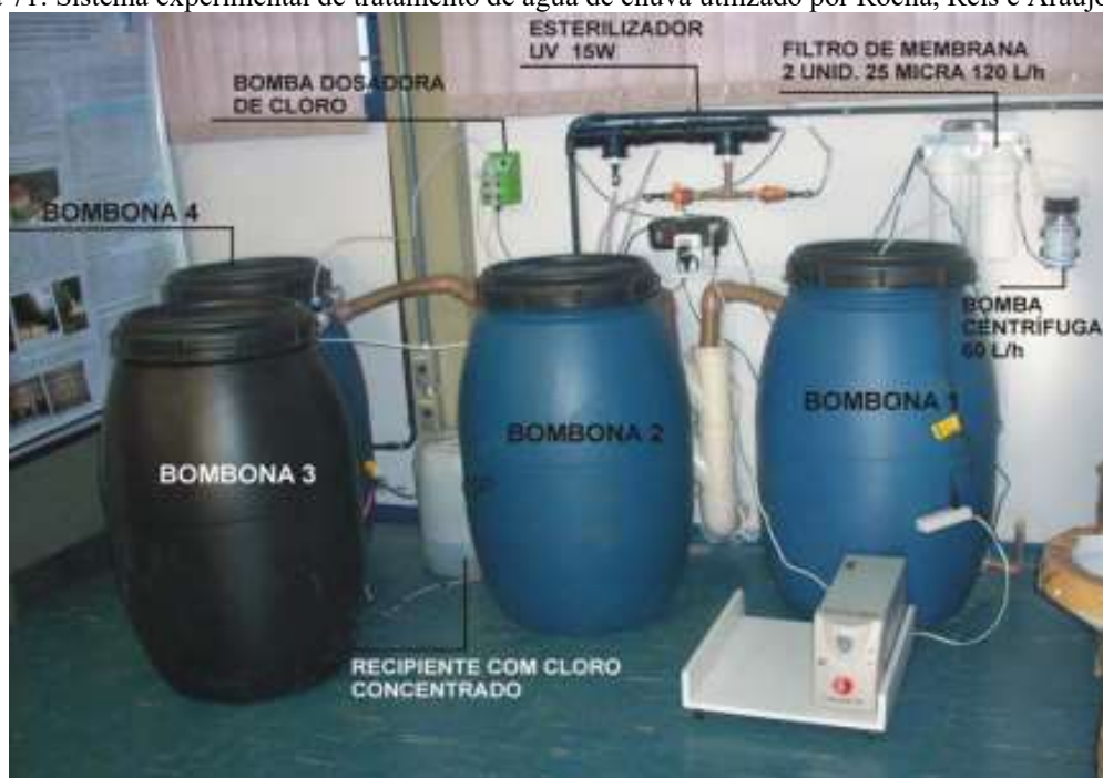
Figura 71: Sistema experimental de tratamento de água de chuva utilizado por Rocha, Reis e Araújo (2011)
