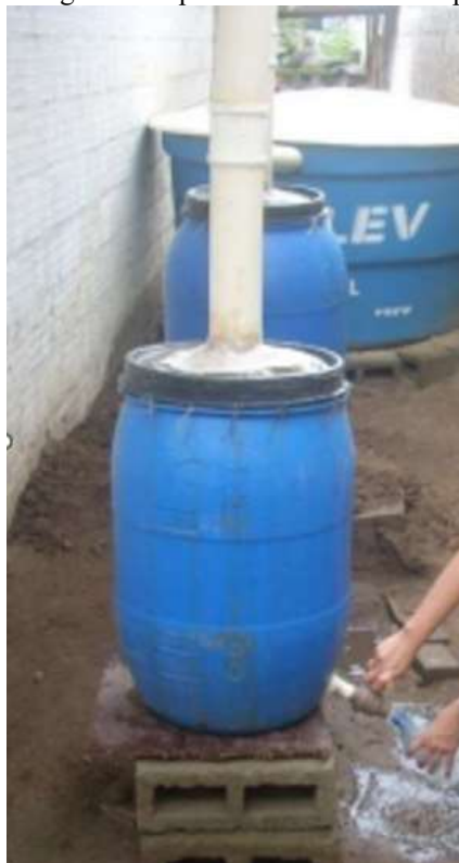
Figura 20: Coleta de água no dispositivo de descarte do primeiro milímetro
