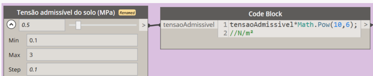
Figura 5.47 – Grupo para pré-dimensionamento das sapatas (trecho 3)
