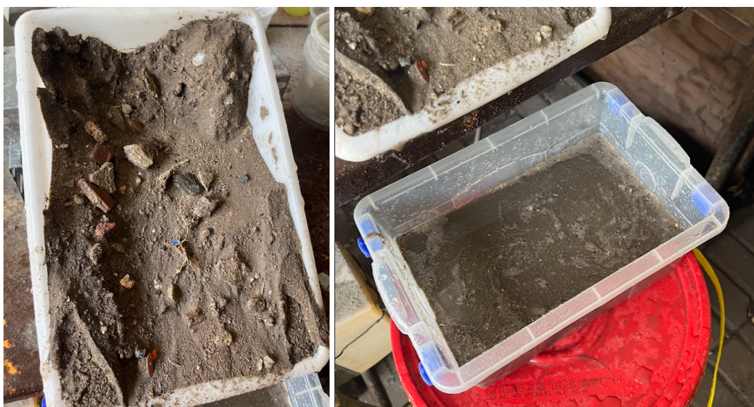
Figura 28: Resultado após simulação de chuva. À esquerda, corpo de prova sem proteção superficial. À direita, partículas de solo carregadas pela água. Fonte: Autor
