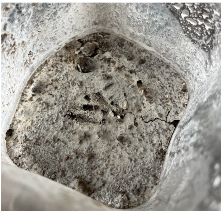
Figura 26: Camada de proteção da mistura cimento, cal e água no 2º teste. Fonte: Autor.
