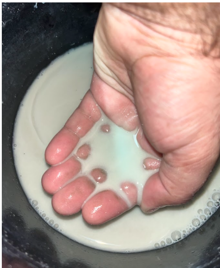
Figura 18: Mistura cimento, cal e água para aplicação com pulverizador. Fonte: Autor.
