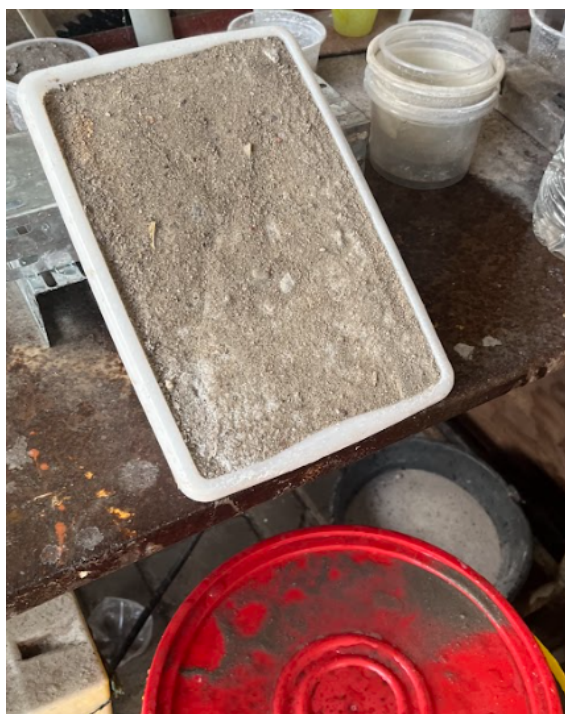
Figura 23: Corpo de prova para teste de escoamento superficial com proteção superficial composta pela mistura tinta:água. Fonte: Autor.
