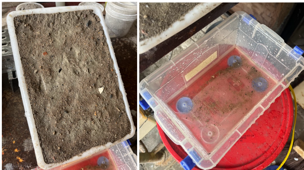
Figura 29: Resultado após simulação de chuva. À esquerda, corpo de prova com proteção superficial cimento:água. À direita, partículas de solo carregadas pela água. Fonte: Autor
