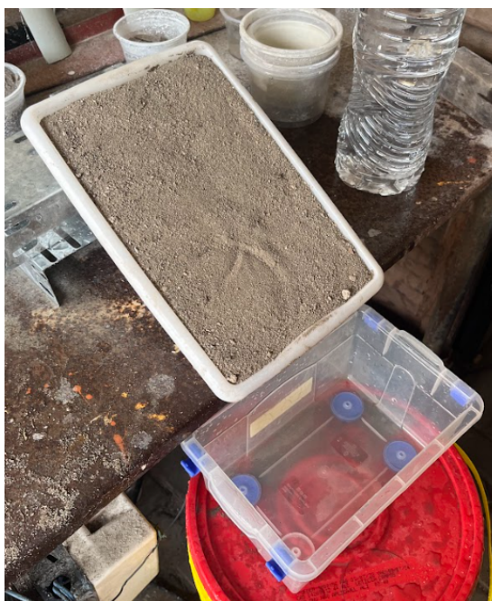
Figura 21: Corpo de prova para teste de escoamento superficial com solo natural. Fonte: Autor.
