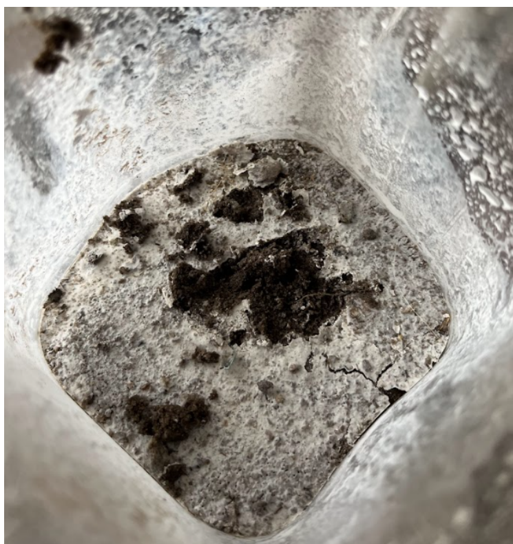
Figura 25: Camada de proteção da mistura cal e água no 2º teste. Fonte: Autor.
