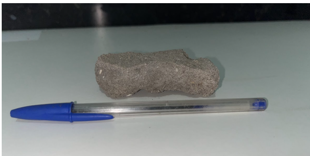
Figura 27: Camada de proteção da mistura tinta e água. Fonte: Autor
