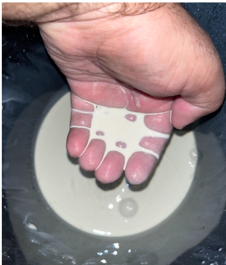
Figura 19: Mistura tinta e água para aplicação com pulverizador. Fonte: Autor.
