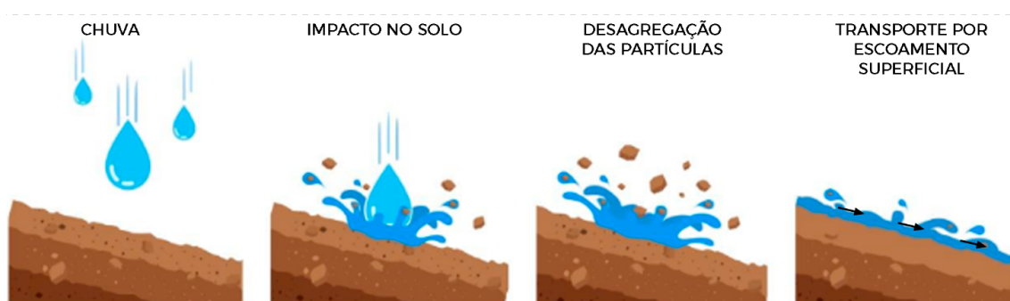
Figura 3: Efeito splash provocando o início do processo erosivo nas encostas. Fonte: BRIZZI, 2018. (modificado pelo Autor).
