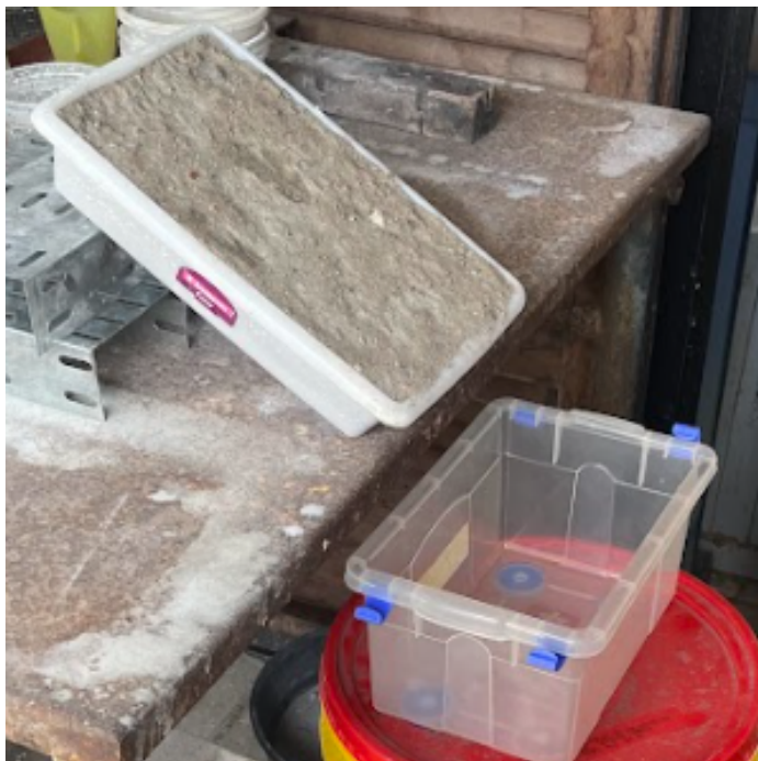
Figura 22: Corpo de prova para teste de escoamento superficial com proteção superficial composta pela mistura cimento:água. Fonte: Autor.
