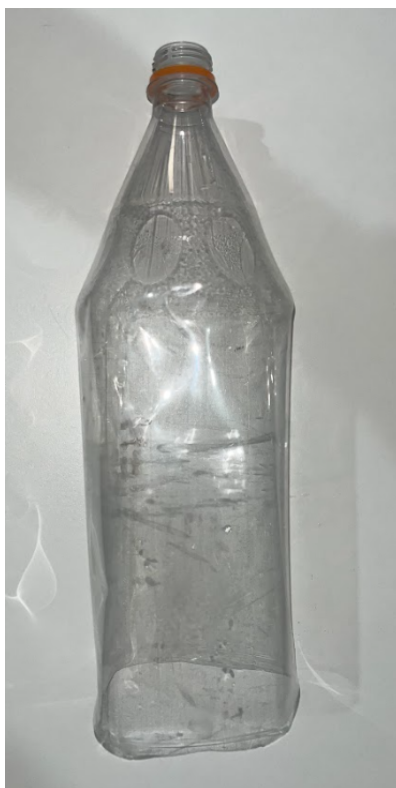
Figura 10: Garrafa cortada utilizada para preenchimento com o solo. Fonte: Autor.
