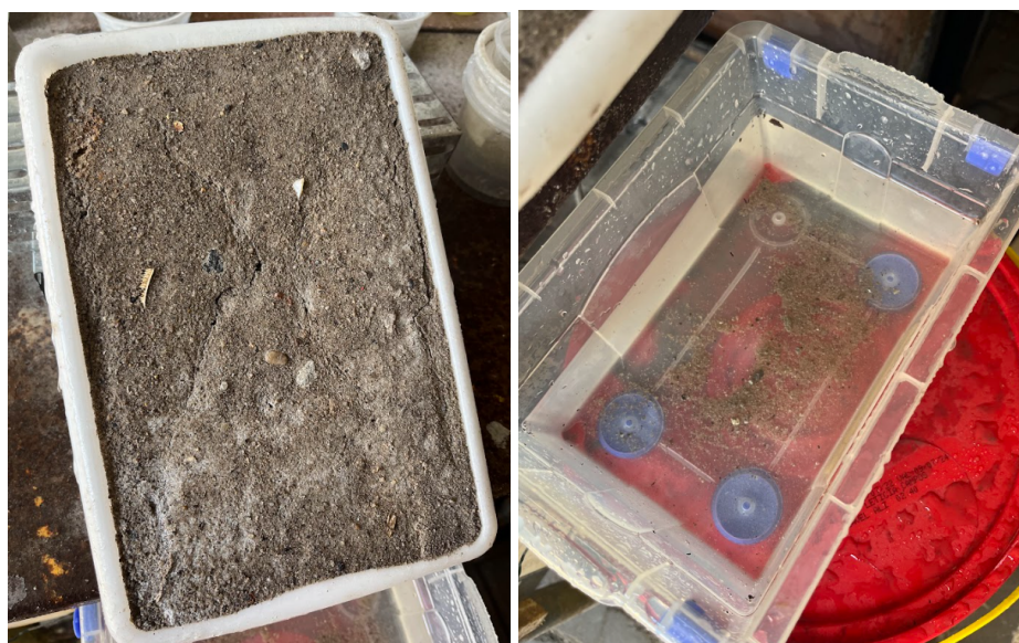
Figura 30: Resultado após simulação de chuva. À esquerda, corpo de prova com proteção superficial tinta:água. À direita, partículas de solo carregadas pela água. Fonte: Autor
