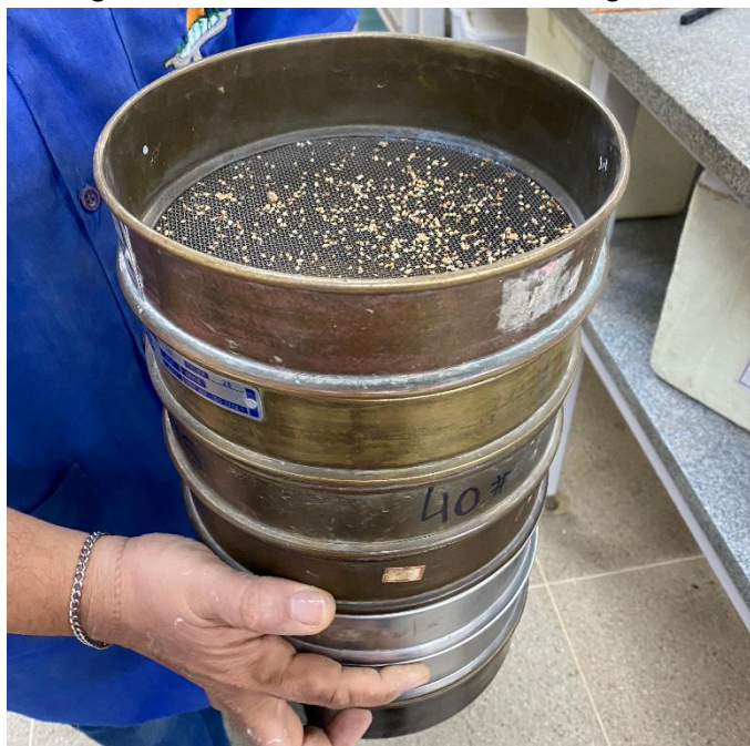
Figura 23 – Peneiramento do solo grosso
