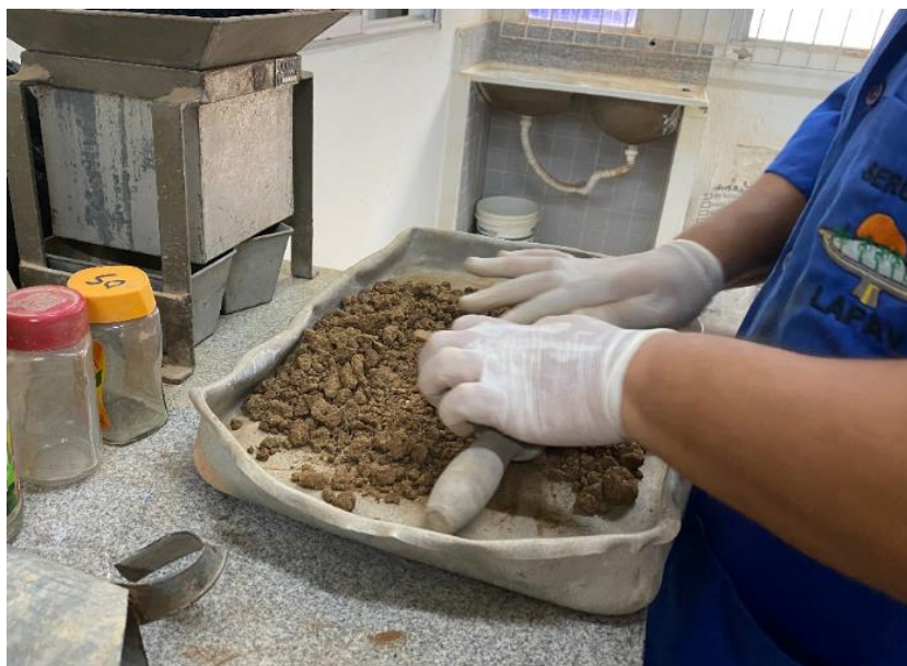
Figura 20 – Destorroamento do solo
