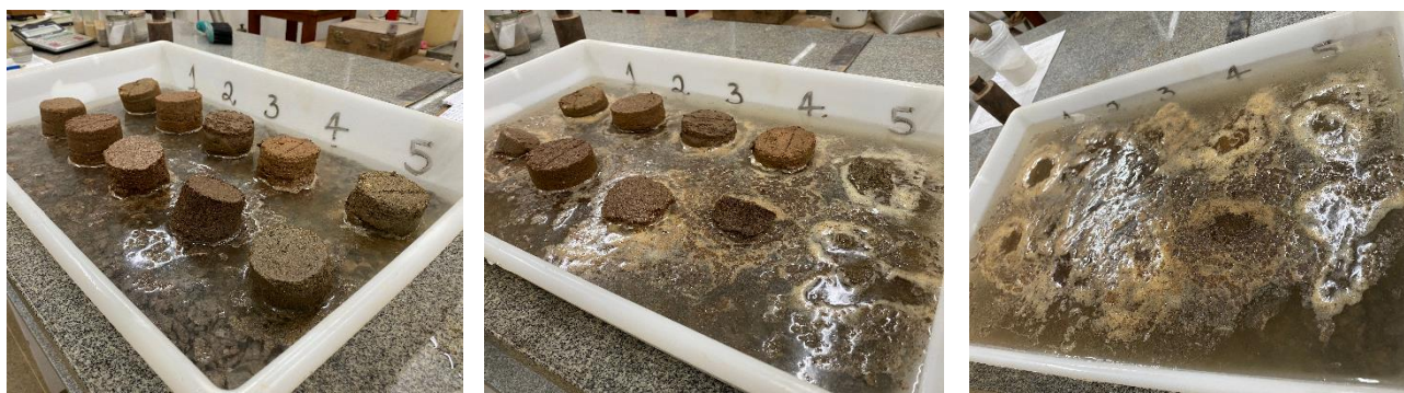
Figura 32 – Segunda, terceira e quarta etapa do Ensaio de Desagregação
