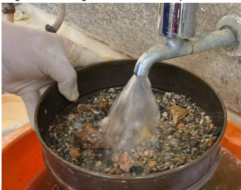
Figura 21 – Lavagem do solo retido na peneira nº 10
