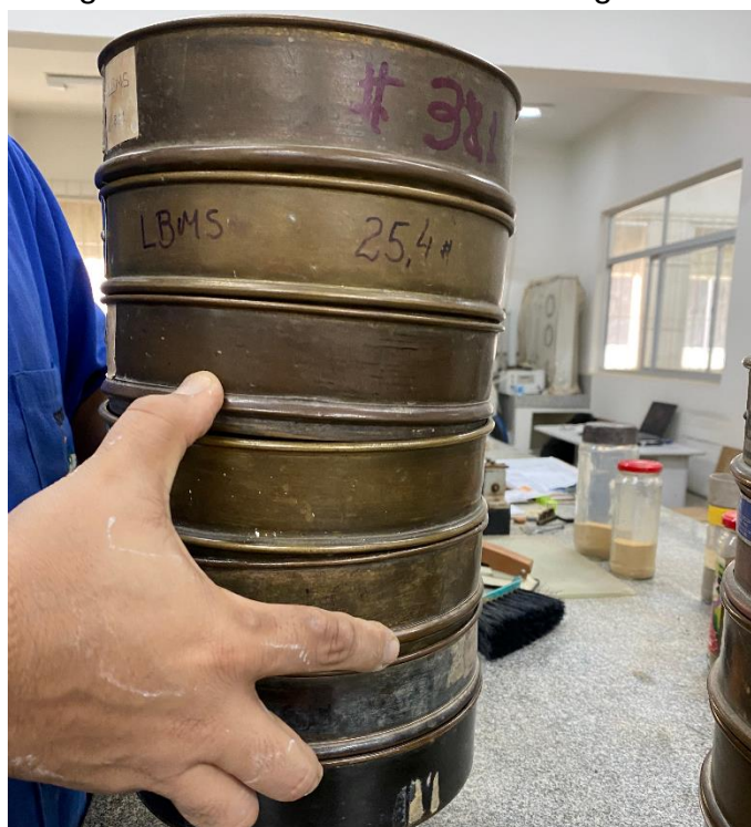
Figura 22 – Peneiramento do solo grosso
