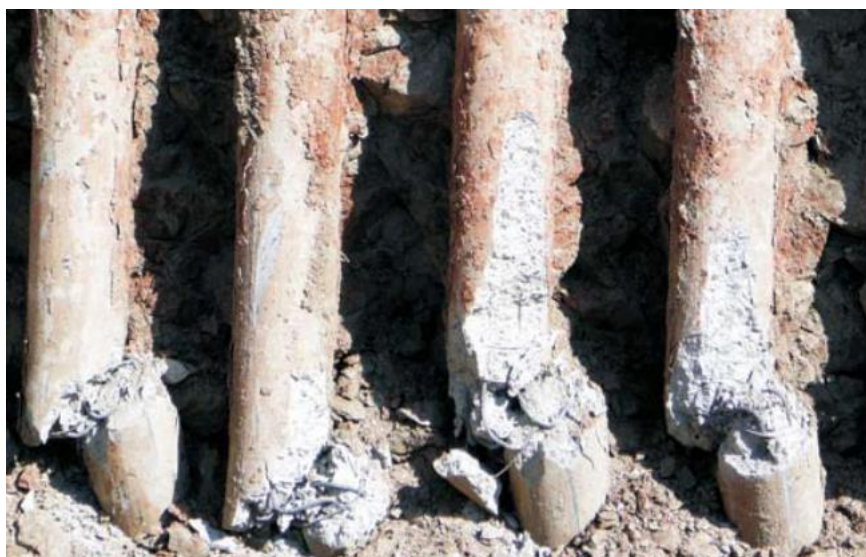
Figura 29 - Ruptura identificada no lado D
