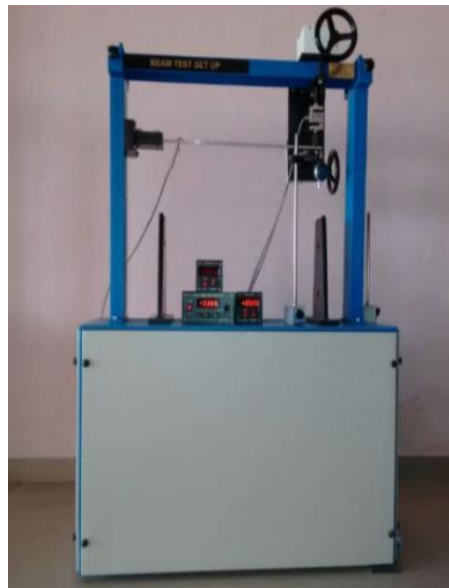
Figura 13 – Maquinário para ensaio de viga engastada em balanço
