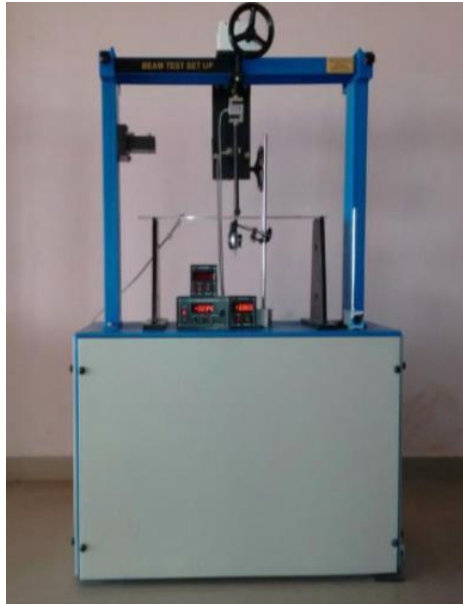
Figura 12 – Maquinário para ensaio de viga biapoada
