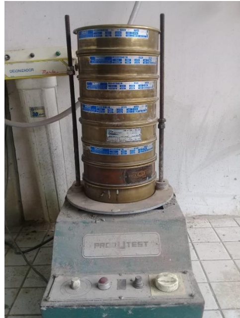
Figura 1 – Peneiramento dos agregados naturais
