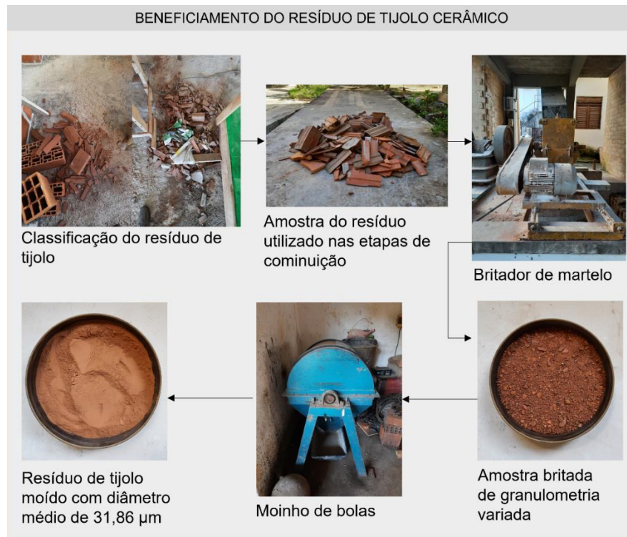
Figura 5 – Etapas para obtenção do RTM
