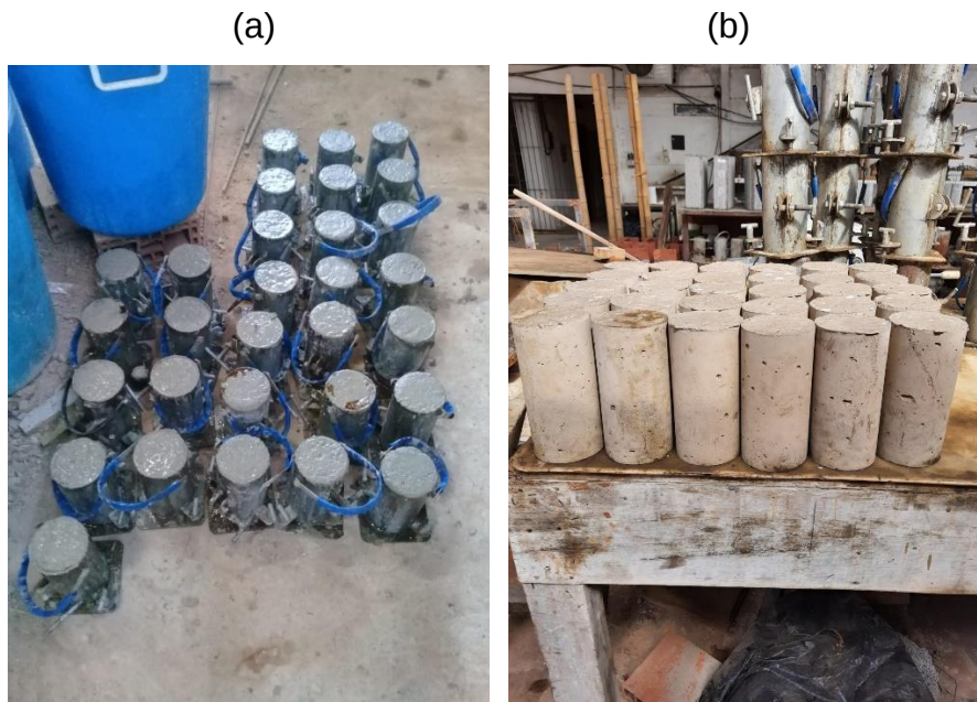
Figura 7 – Moldagem dos corpos de prova (a) e amostras no estado endurecido (b)
