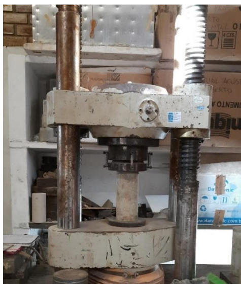
Figura 8 – Ensaio de resistência à compressão axial
