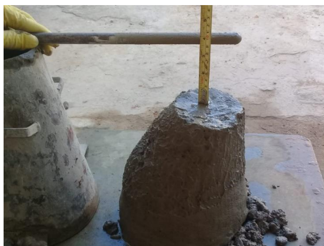
Figura 11 – Ensaio de abatimento ( slump )
