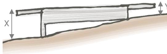
**Figura 108** - Croqui da estrutura do deck em comparação ao nível do solo.
