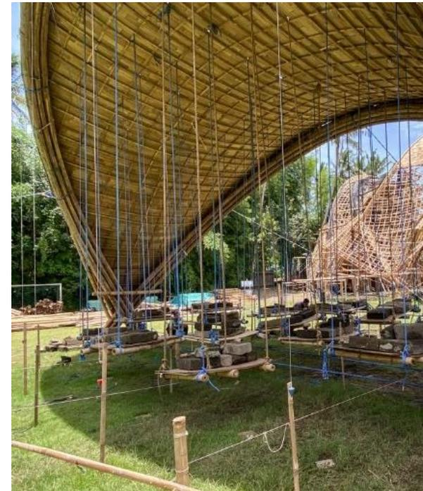
**Figura 89** - Modelo para teste estrutural das *gridshells*.
