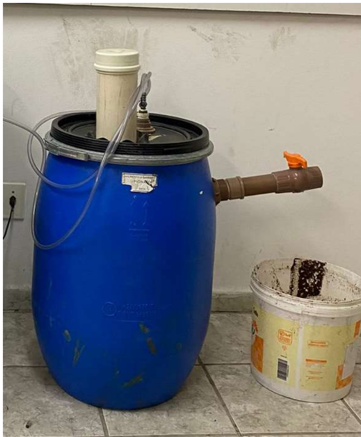
Figura 34 - Biodigestor de Bombona Plástica
