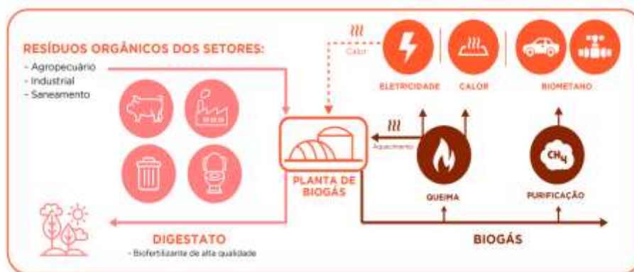
Figura 15 - Substratos e Produtos na Usina de Biogás
