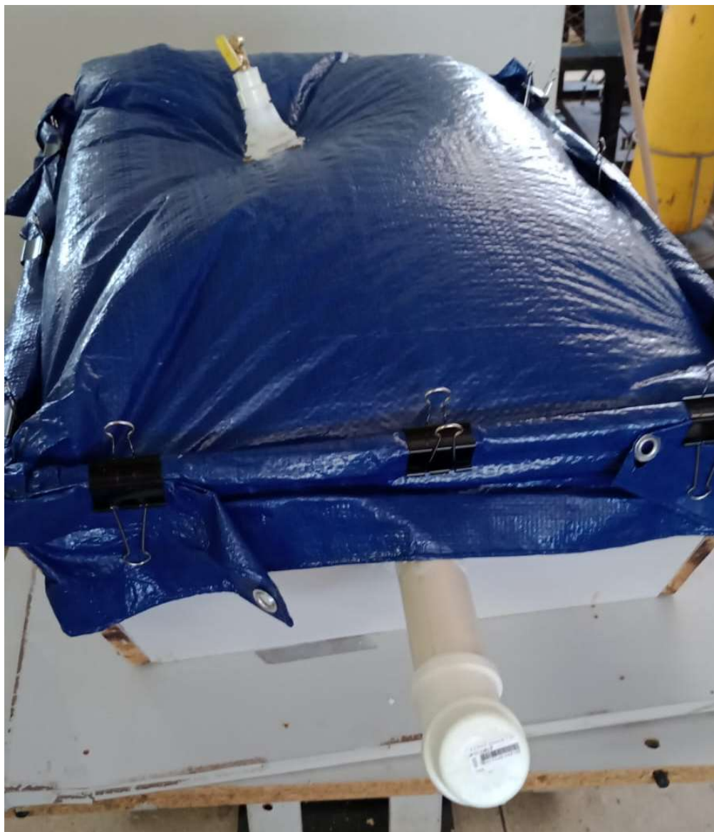
Figura 32 - Protótipo de Biodigestor em funcionamento
