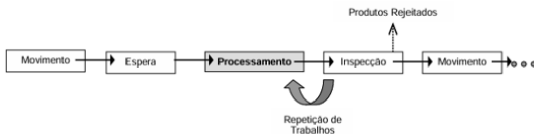
Figura 2 – Modelo de processo da Lean Construction
