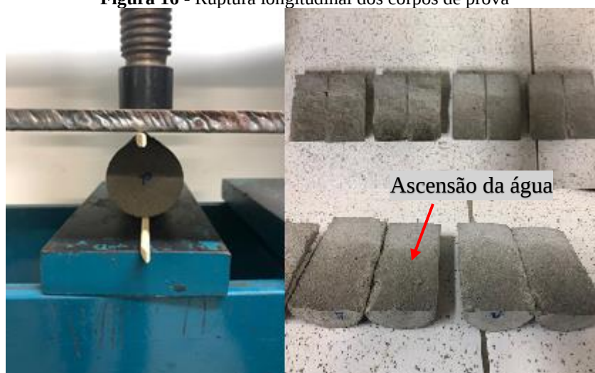
Figura 16 - Ruptura longitudinal dos corpos de prova
