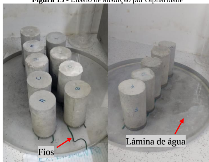
Figura 15 - Ensaio de absorção por capilaridade
