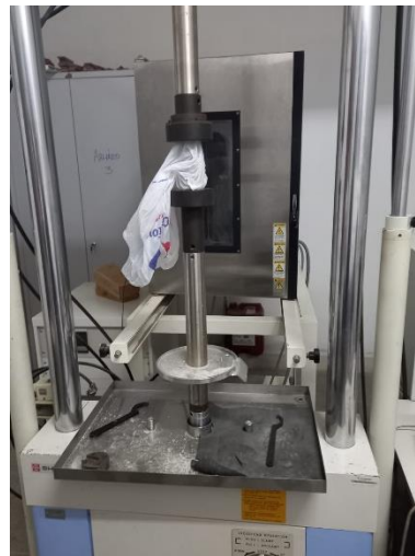
Figura 09 - Ensaio de Resistência à Compressão
