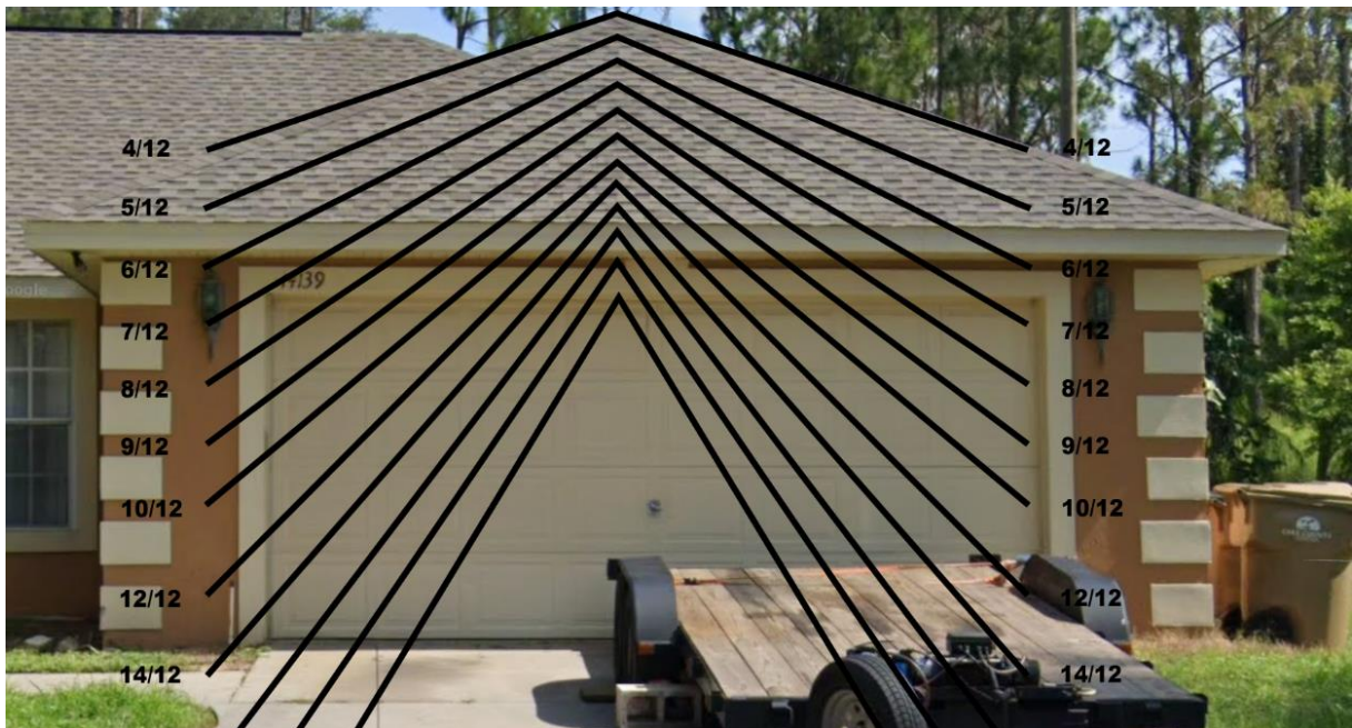
Figura 21 - Medidas da inclinação retirada do RoofR™
