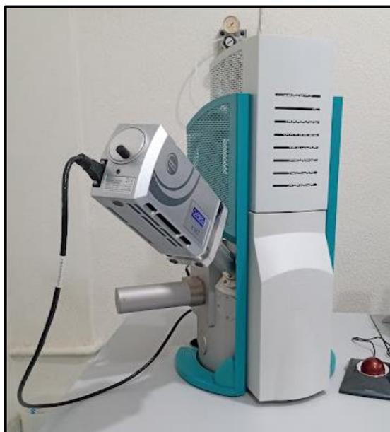
Figura 23 - Microscópio Vega-3 LMU TESCAN.
