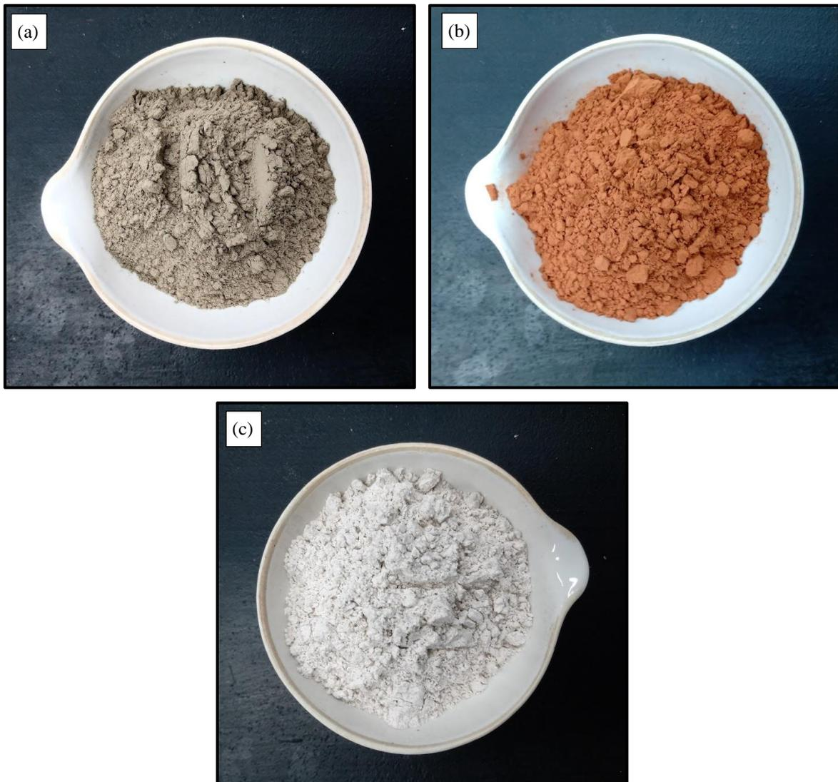
Figura 19 - Aspecto das matérias-primas beneficiadas: (a) Argila vermelha, (b) Resíduo cerâmico, (c) Resíduo de diatomita.
