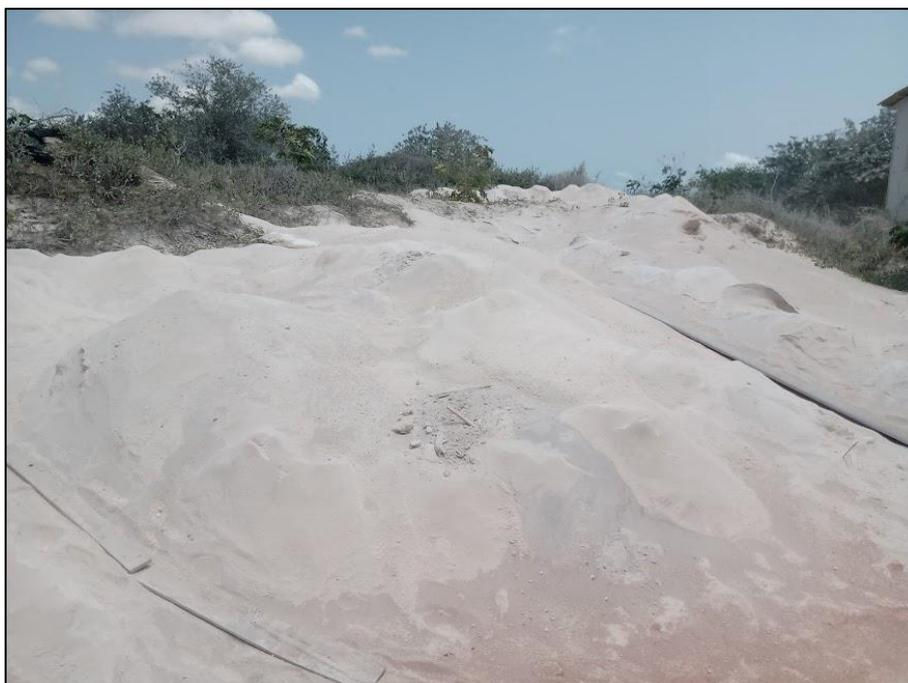
Figura 8 - Acúmulo de diatomita de baixo grau nas instalações de uma pequena mineradora, Rio do Fogo-RN.
