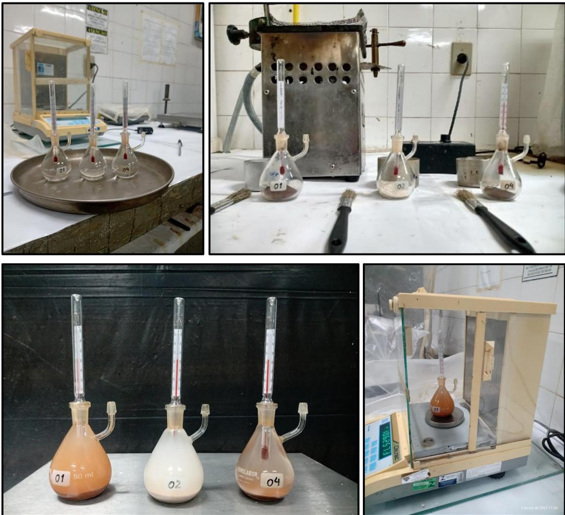
Figura 28 - Procedimentos adotados no ensaio de densidade real.
