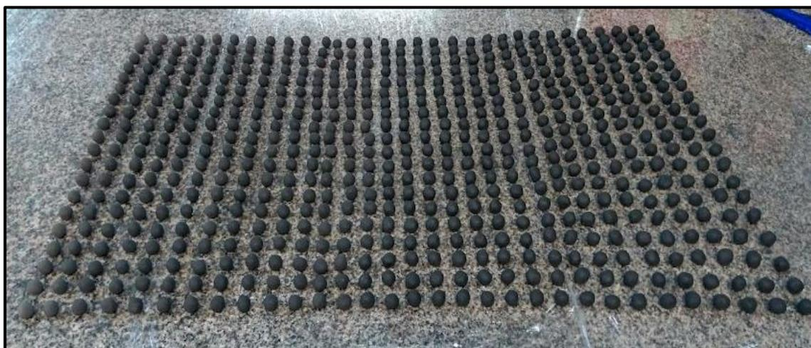
Figura 25 - Aspecto das amostras após homogeneização e conformação
