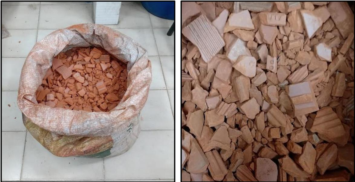
Figura 14 - Amostra de resíduo cerâmico utilizado na pesquisa.
