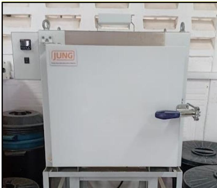
Figura 22 - Forno de câmara trifásico JUNG.
