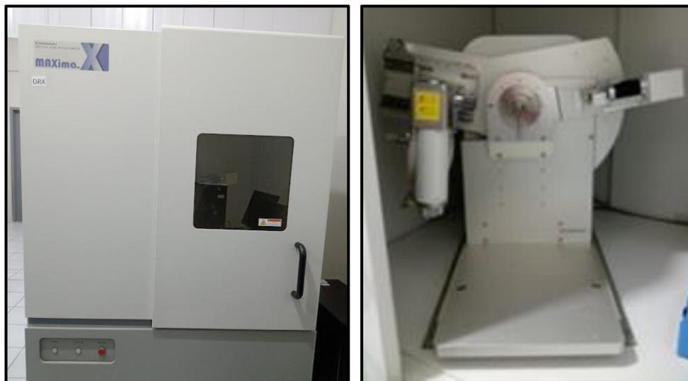
Figura 21 - Difratorômetro de raios-x Shimadzu, XRD-7000.
