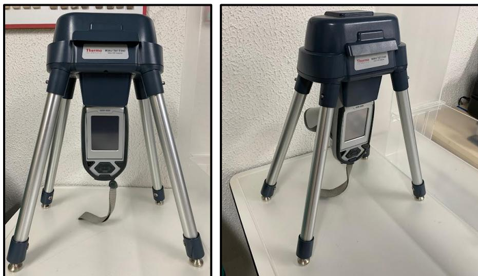
Figura 20 - Espectrômetro portátil Thermo Scientific Niton XL3T. Fonte: LT2M/IFRN.
