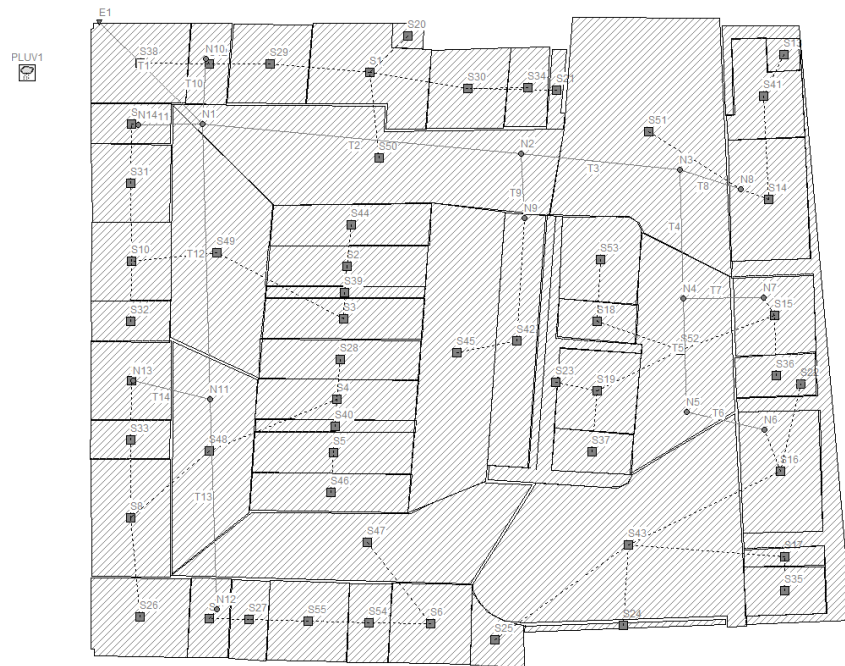
Figura 24 - Modelo do C01 no SWMM.
