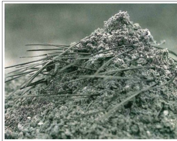
Figura 1 – Demonstração da estabilização de areia com agulhas de pinheiro, inspirando a técnica Terre Armée de Henry Vidal
