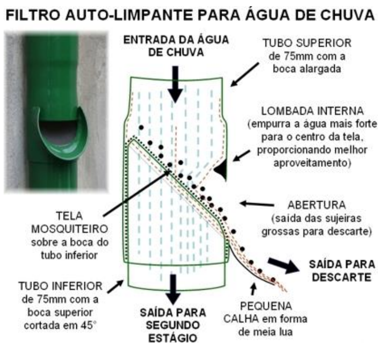
Figura 14 – Esquema de funcionamento do filtro de baixo custo
