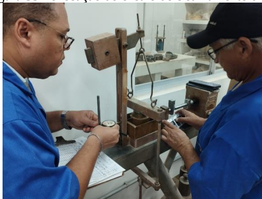
Figura 53 - execução do ensaio de cisalhamento direto
