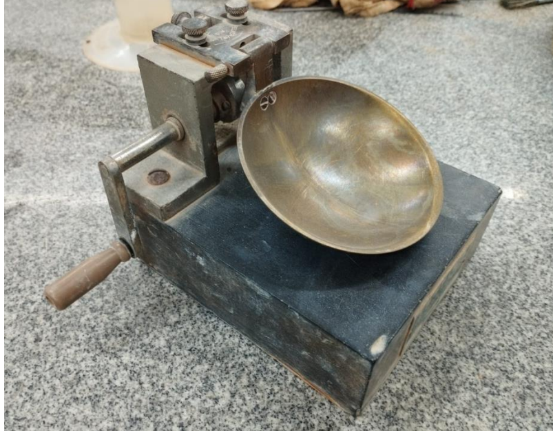
Figura 46 – aparelho Casagrande para execução do ensaio de Limites de Consistência
