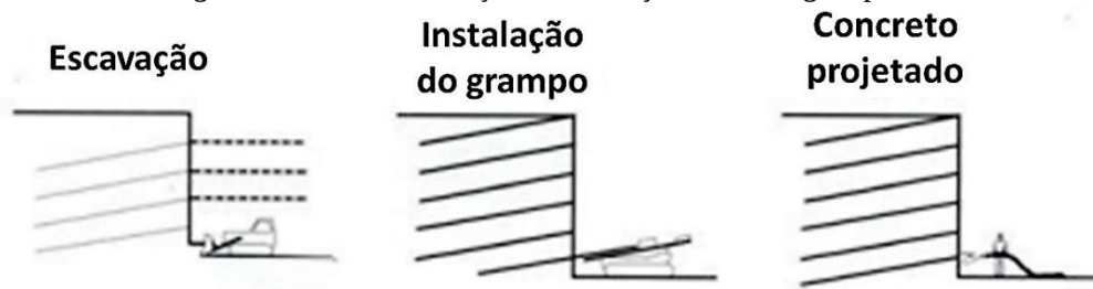
Figura 32 - fases de execução da contenção com solo grampeado
