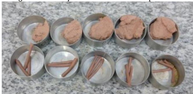
Figura 49 - execução do ensaio de limite de plasticidade
