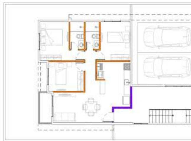
Figura 15 – Vedação de blocos cerâmicos no Pav. Tipo
