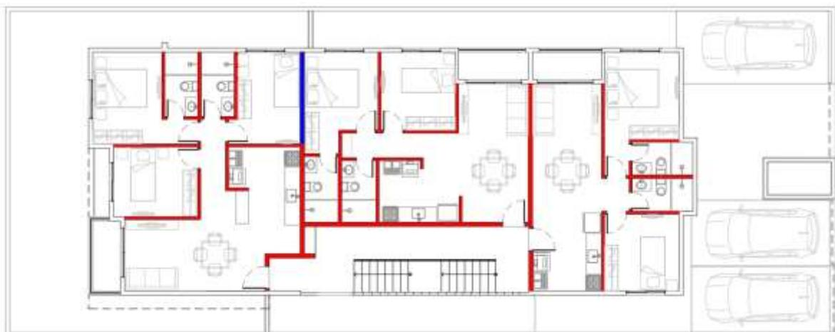
O único trecho desconsiderado para comparação foi a vedação entre dormitórios dos tipos 01 e 02, em azul na figura 13, pela necessidade de aplicação de paredes distintas para
