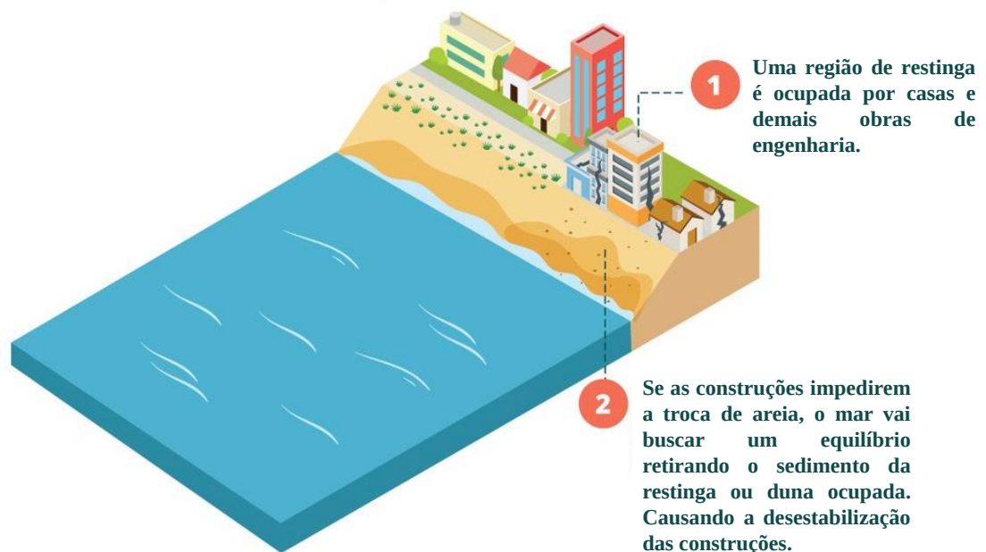
Figura 7 – Efeitos da erosão nas construções em áreas costeiras
