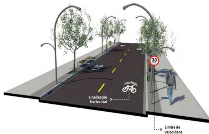
Figura 07: Sinalização com indicação de limite de velocidade em ciclorrota
