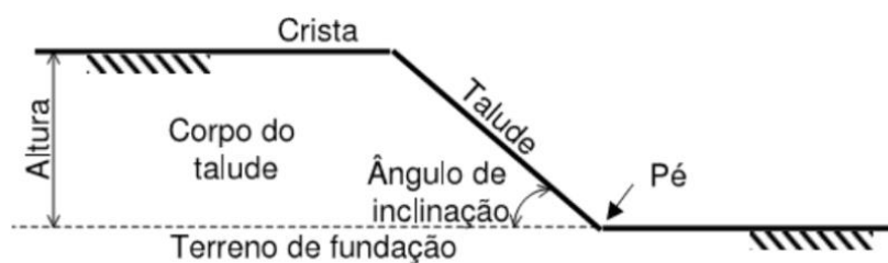
Figura 5 - Composição de um talude
