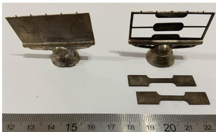
Ao todo, foram fabricadas três placas retangulares para a extração dos corpos de prova de tração, utilizando dois lingotes diferentes.
