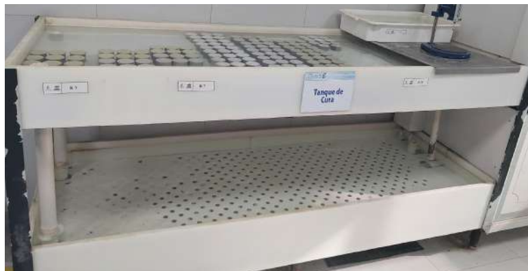
Figura 37 - Tanque de cura.
