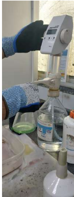
Figura 25 - Titulação com solução de ácido clorídrico para ensaio de Cal Livre.
