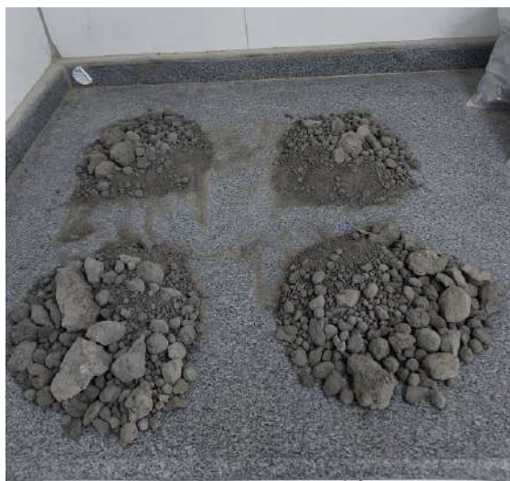
Figura 20 - Quarteamento da amostra de clínquer.
