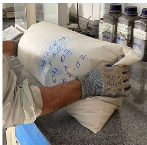
Figura 30 - Exemplo de homogeneização de cimento em sacos plásticos.
