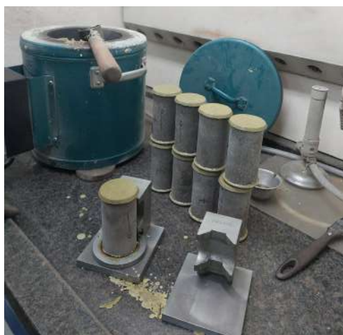
Figura 36 - Capeamento dos corpos de prova com enxofre.
