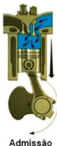
Figura 1: Primeira etapa do ciclo diesel – Admissão de ar no cilindro
