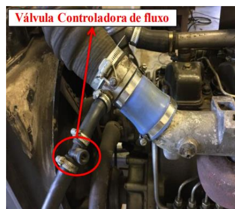
Figura 15: Componentes da adaptação mecânica: (a) misturador do tipo "boca de fogão" instalado e (b) válvula manual controladora de fluxo.
