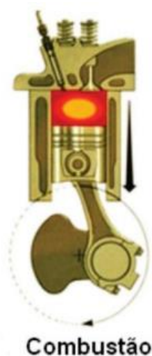
Figura 4: Terceira etapa do ciclo diesel – Combustão e expansão
