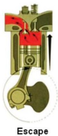
Figura 5: Quarta etapa do ciclo diesel – Exaustão dos gases
