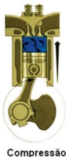
Figura 3: Segunda etapa do ciclo diesel – Compressão do ar
