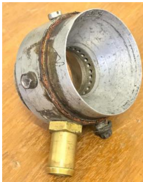
Figura 14: Misturador do tipo 'boca de fogão' desenvolvido no LI
