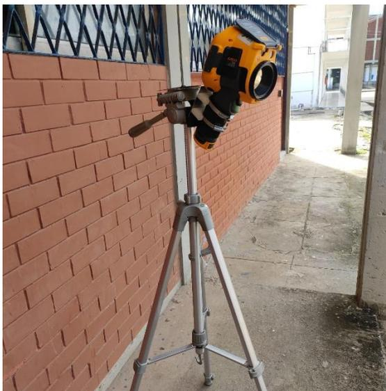
Figura 8.1 - Câmera térmica utilizada para realização do experimento.
