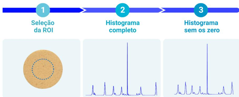
**Figura 2.4** - Esquema da aquisição das imagens digitais e extração do histograma, os quais guardam a informação analítica. Elaborado no [biorender.com](https://biorender.com)
