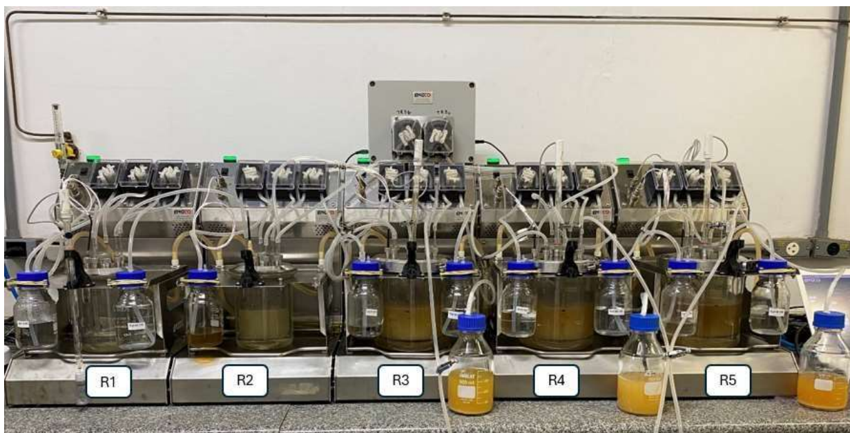
Figura 4. Simulador do Ecosistema Microbiano Humano (SHIME®)
