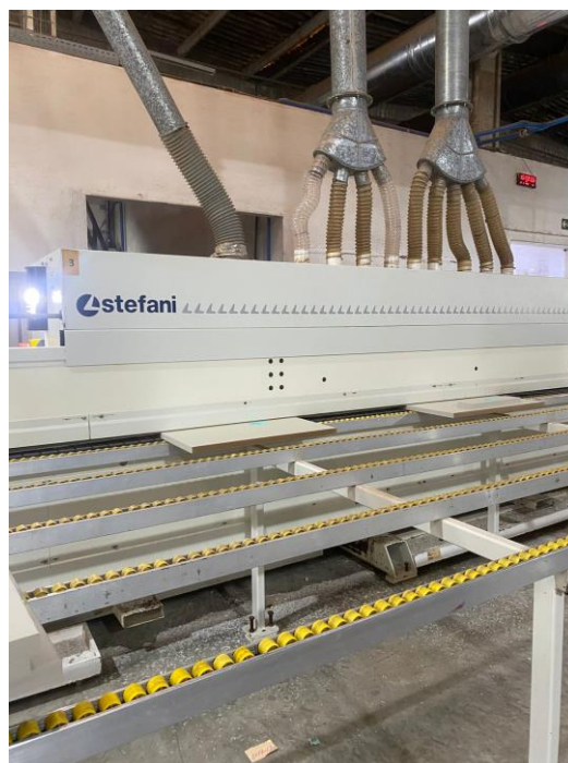
Figura 8 - Máquina que realiza fitagem e furação
